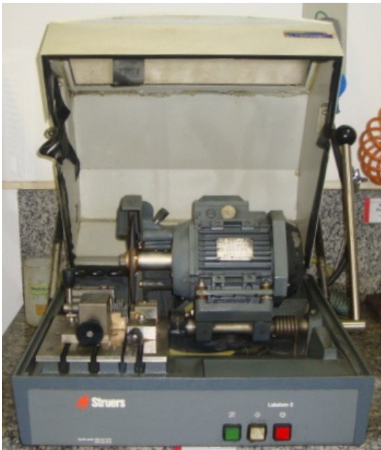
Figura 13: Máquina de corte Labotom-3 Marca Struers e embutidora EMHP40 Marca TECLAGO utilizadas para preparação dos corpos de prova
