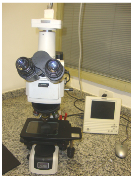
Figura 15: Microscópio Óptico NIKON Eclipse LV150 utilizado nas análises metalográficas
