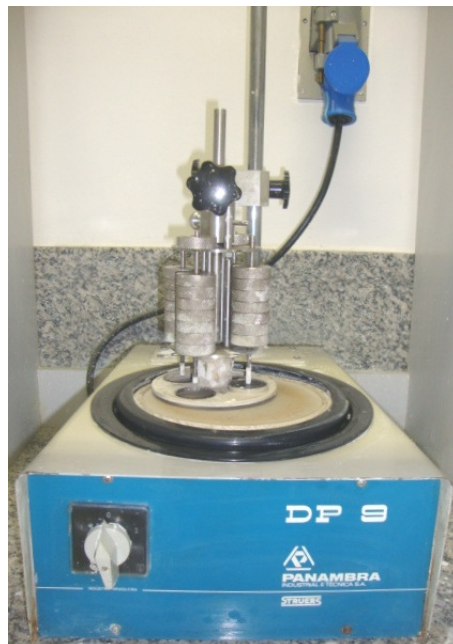
Figura 14: Lixadeira LaboPol-2 Marca Struers e politriz Pananbra DP9 Struers utilizada para preparação dos corpos de prova
