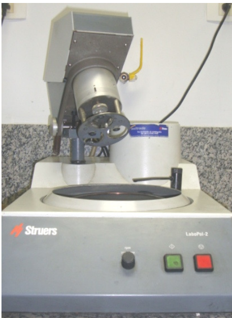
Figura 14: Lixadeira LaboPol-2 Marca Struers e politriz Pananbra DP9 Struers utilizada para preparação dos corpos de prova
