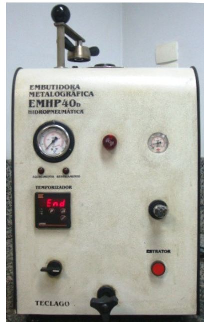
Figura 13: Máquina de corte Labotom-3 Marca Struers e embutidora EMHP40 Marca TECLAGO utilizadas para preparação dos corpos de prova
