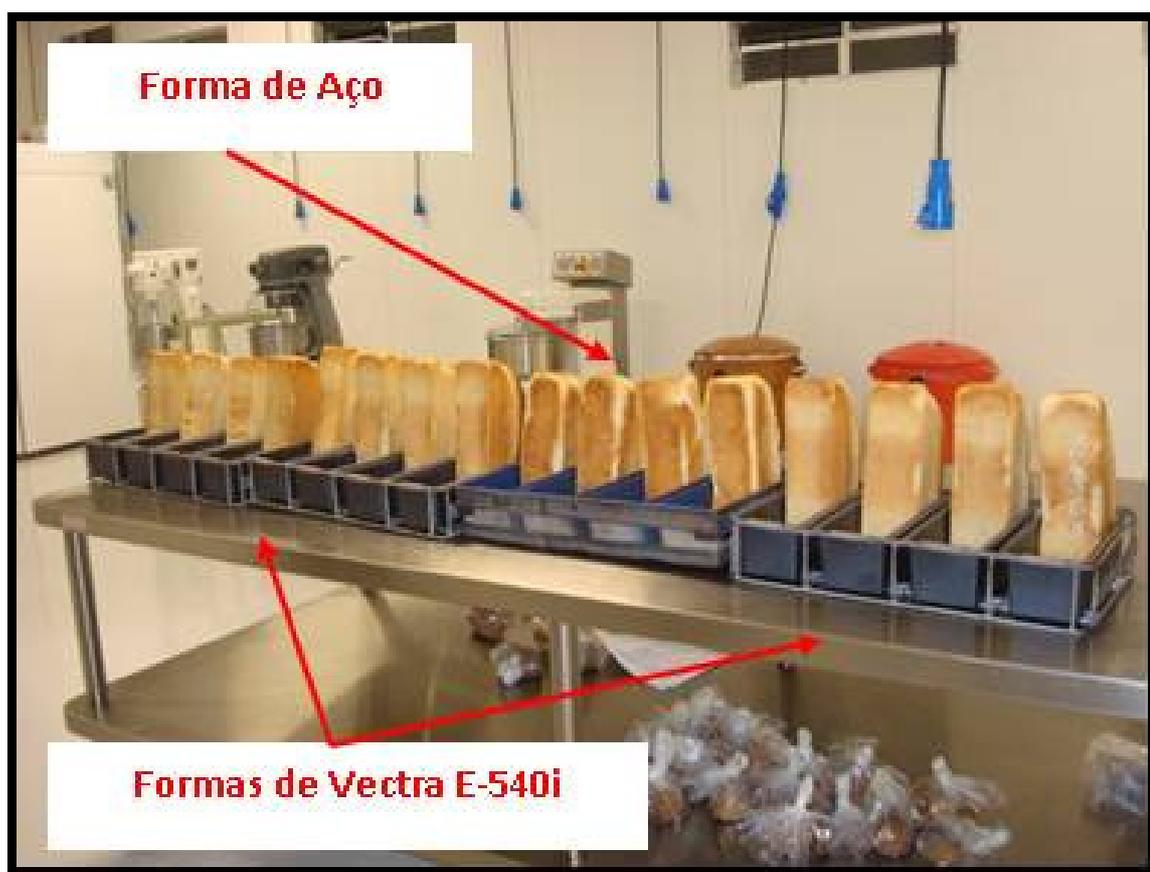
Fotografia 42 - Análise visual de parte inferior de pães após assamento em formas de Vectra e em formas de aço.
