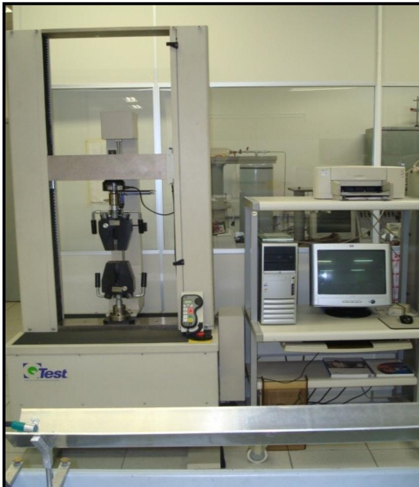
Fotografia 9 – Equipamento para ensaio de tração Q-Test
