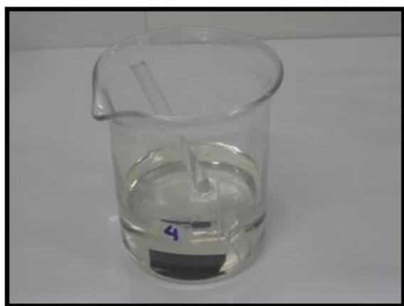
Fotografia 28 – Corpo de prova em H<sub>2</sub>SO<sub>4</sub> 80 %, logo após imersão
