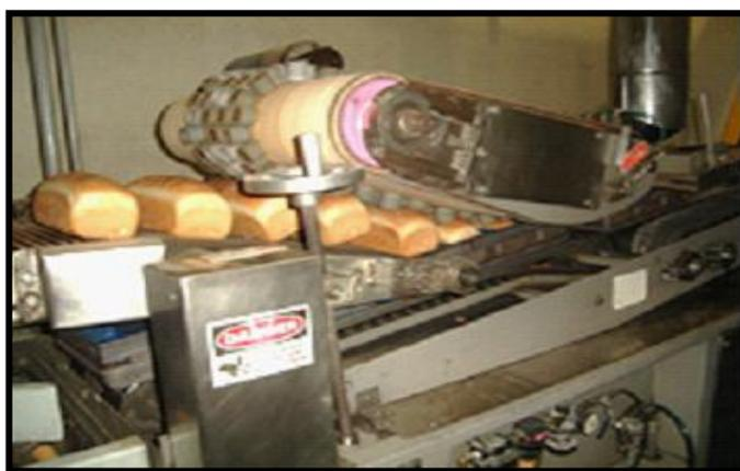
Fotografia 5 - *Depanner*, equipamento localizado após o forno
