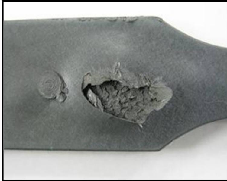
Fotografia 15 - Corpo de prova após tratamento térmico a 300°C.
