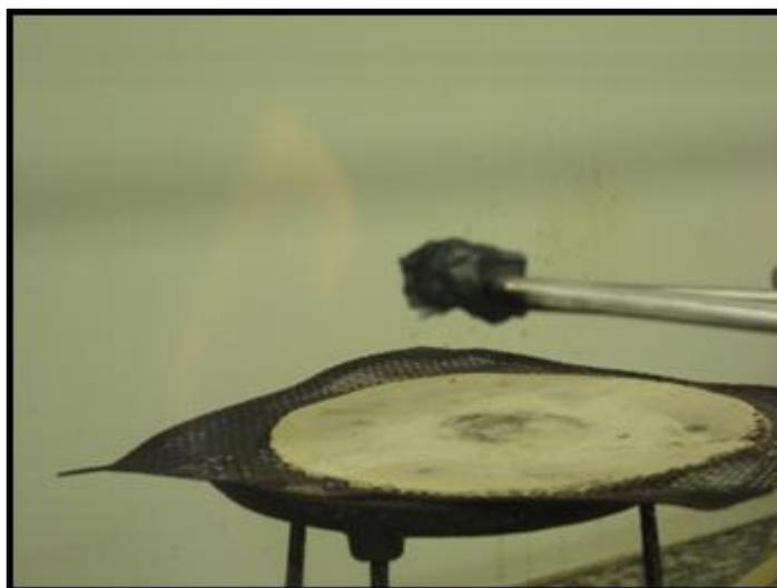
Fotografia 24 – Ensaio de inflamabilidade Ausência da fonte de chama
