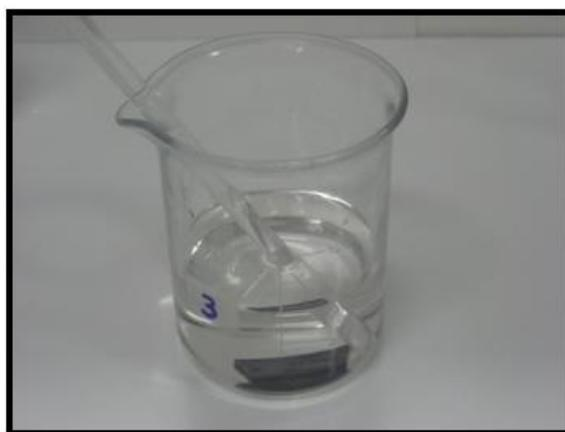
Fotografia 27 – Corpo de prova em H<sub>2</sub>SO<sub>4</sub> 60 %, logo após imersão
