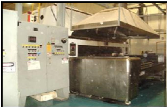
Fotografia 3 – Sistema de entrada e saída do forno
