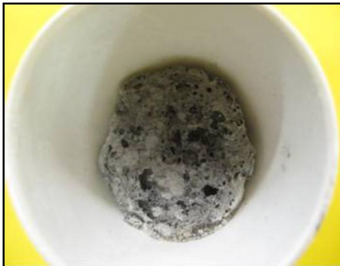
Fotografia 19 - Corpo de prova a 500°C
