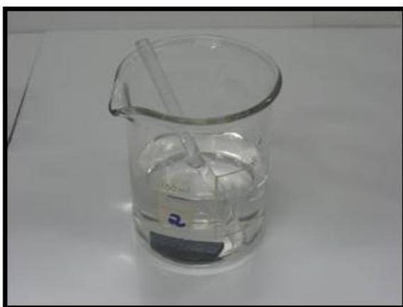
Fotografia 26 – Corpo de prova em H<sub>2</sub>SO<sub>4</sub> 40 %, logo após imersão
