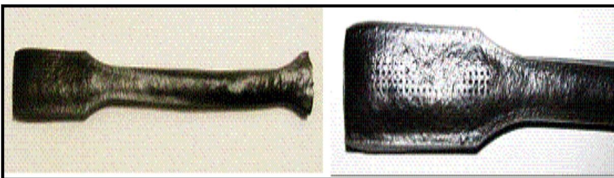
Fotografia 14 - Corpo de prova com tratamento térmico de 300°C
