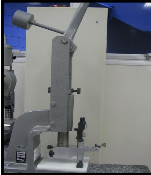
Fotografia 13 – Sistema para ensaio de dureza Shore
