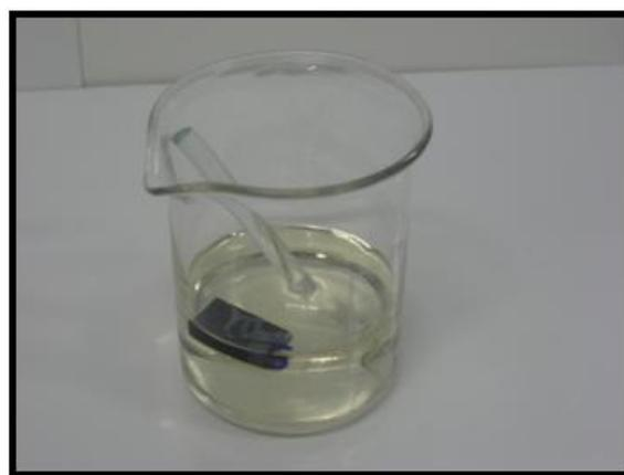
Fotografia 29 – Corpo de prova em H<sub>2</sub>SO<sub>4</sub> 98 %, logo após imersão
