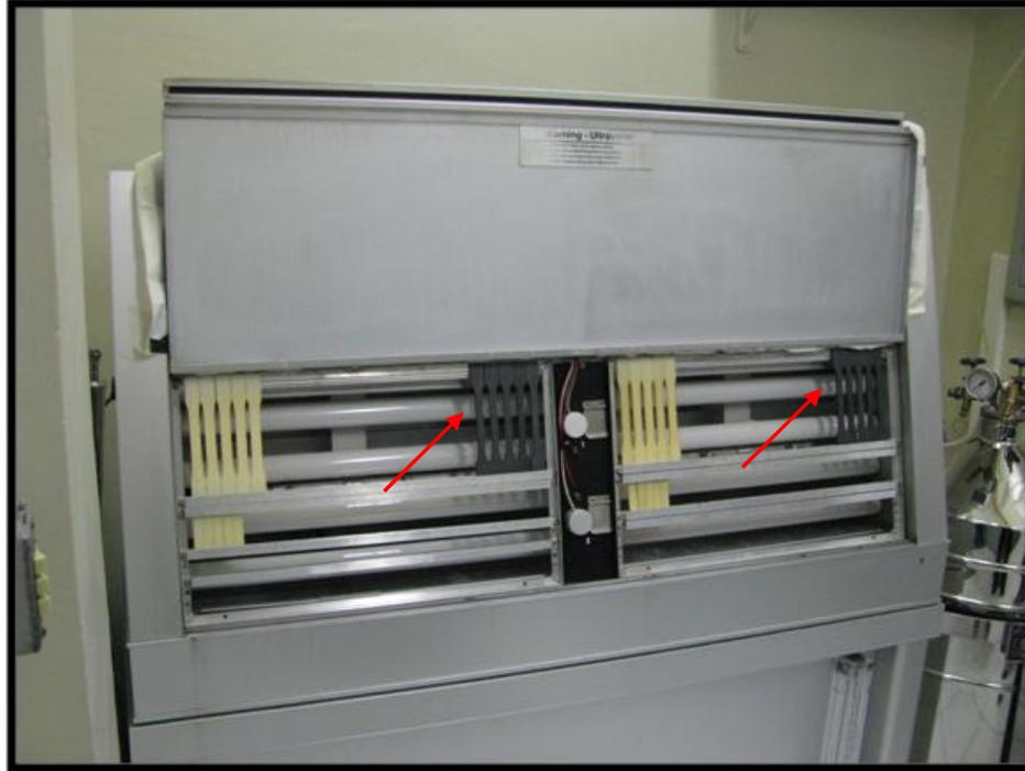
Fotografia 33 - Posicionamento dos corpos de prova no equipamento para ensaio de radiação Ultravioleta. Extremidade inferior dos corpos de prova apoiada no equipamento.
