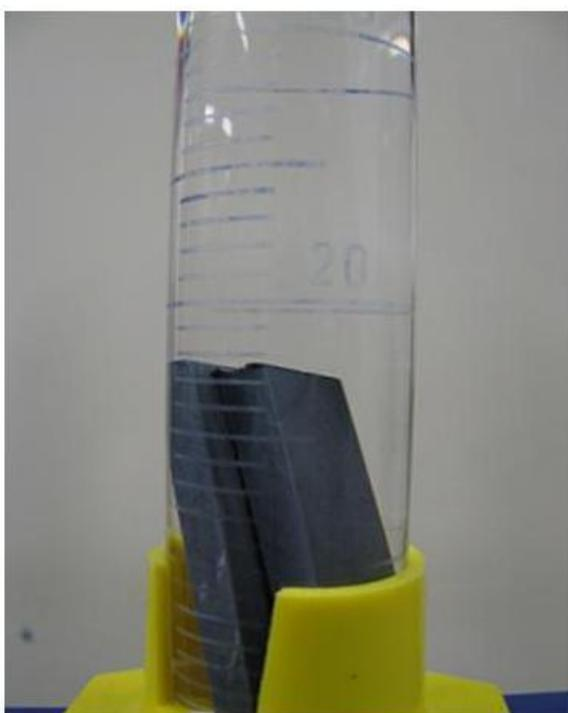
Fotografia 25 – Corpo de prova do Vectra E540i em H<sub>2</sub>O desmineralizada, após 400 dias.
