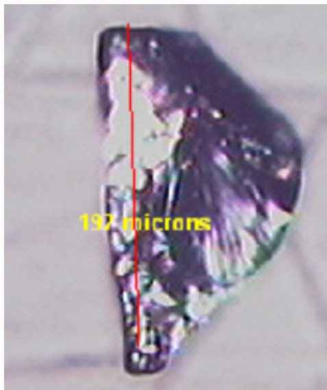
FIGURA 48: Partícula de Cromo. Ampliação 200x.
