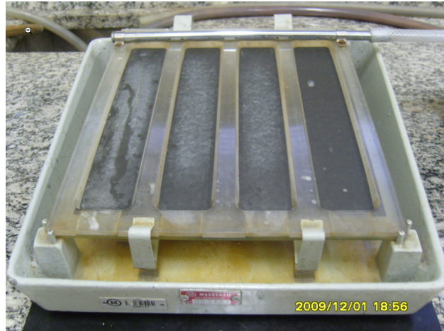
FIGURA 30: Rampa para com refrigeração à base de água
