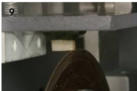
Anexo 9: Espécime sendo cortado na cortadeira metalográfica
