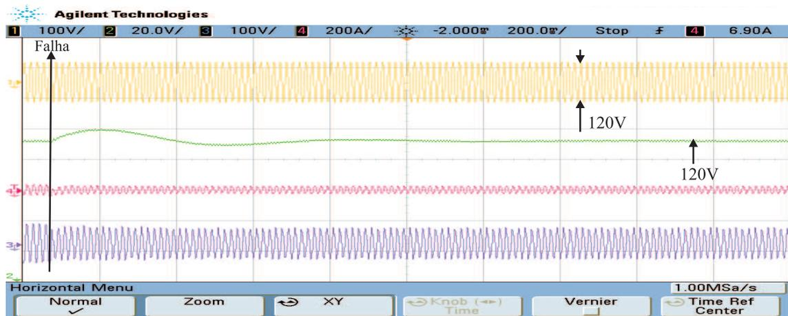
Figura 3.31: Falha ocorrida num sincronismo fora do intervalo ótimo de tensão de barramento (na mesma tela são representadas de cima para baixo:  $e_g$ ,  $E$ ,  $i_g$ ,  $v_{23}$ .)
