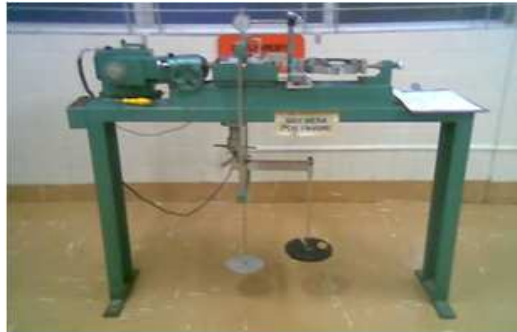
Figura 3.4 Ensaio de Cisalhamento Direto.
