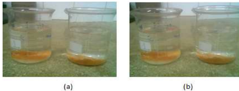
Figura 4.16 Crumb-Test T1A - a) Início do ensaio e b) Término do ensaio após 1h.
