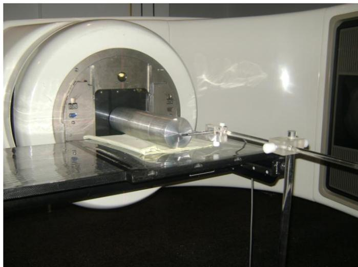
Figura 12: Aparato experimental utilizado para realização das medidas de transmissão em alumínio.
