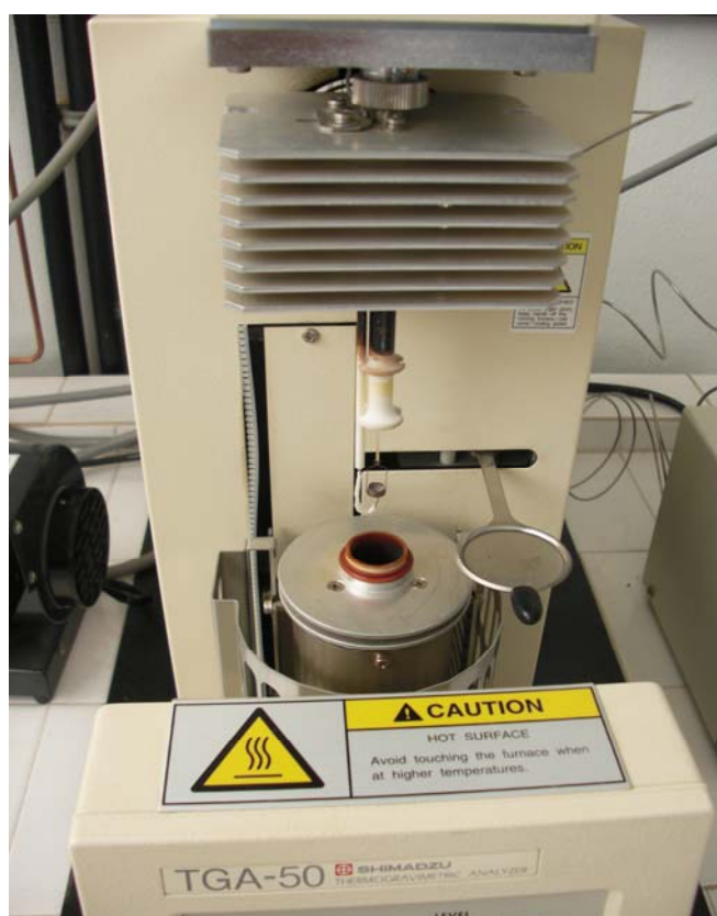
Figura 3.1. Termobalança podendo-se observar o cadinho no porta- amostra e o forno aberto.
