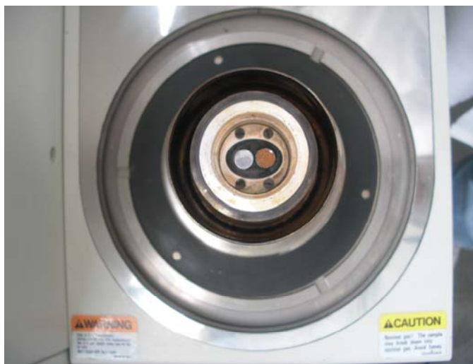
Figura 3.3. Forno DSC mostrando as posições de referência (à direita cadinho vazio) e da amostra (à esquerda).
