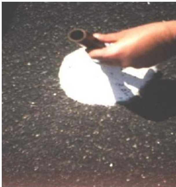
Figura 2. 23: Exemplo de um Ensaio da Mancha de Areia
