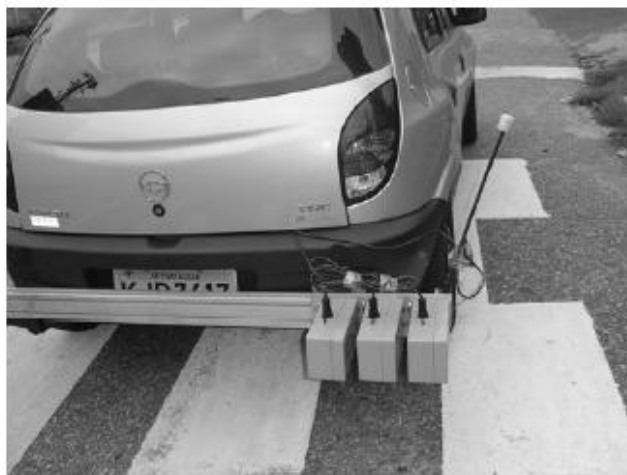
Figura 2. 22: Exemplo de Perfilômetro a laser da Cibernétrica
