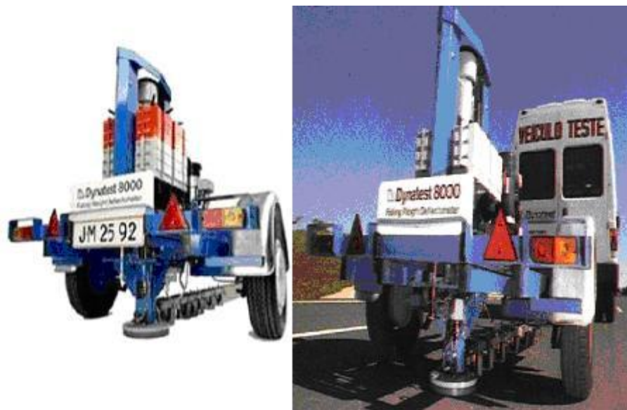
Figura 2. 26: Exemplo de FWD – Falling Weight Deflectometer da marca Dynaest
