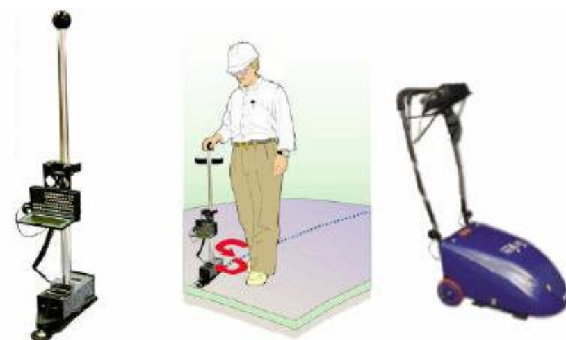
Figura 2.15: Fotografia do Dipstick (esq.); desenho esquemático do Dipstick em operação (centro); e fotografia do perfilômetro Walking Profiler (dir.) (BARELLA, 2008)
