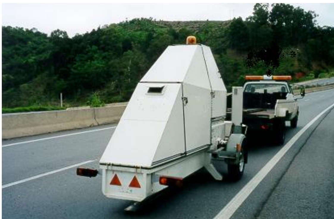
Figura 2. 25: Exemplo de FWD – Falling Weight Deflectometer da marca KUAB
