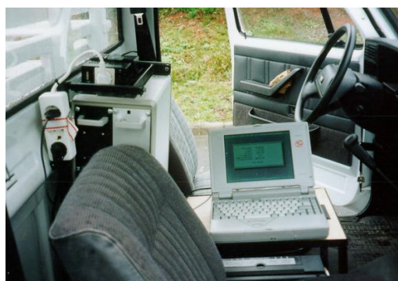
Figura 2. 27: Exemplo de sistema de aquisição de dados e controle de operação de um FWD – Falling Weight Deflectometer visão interna
