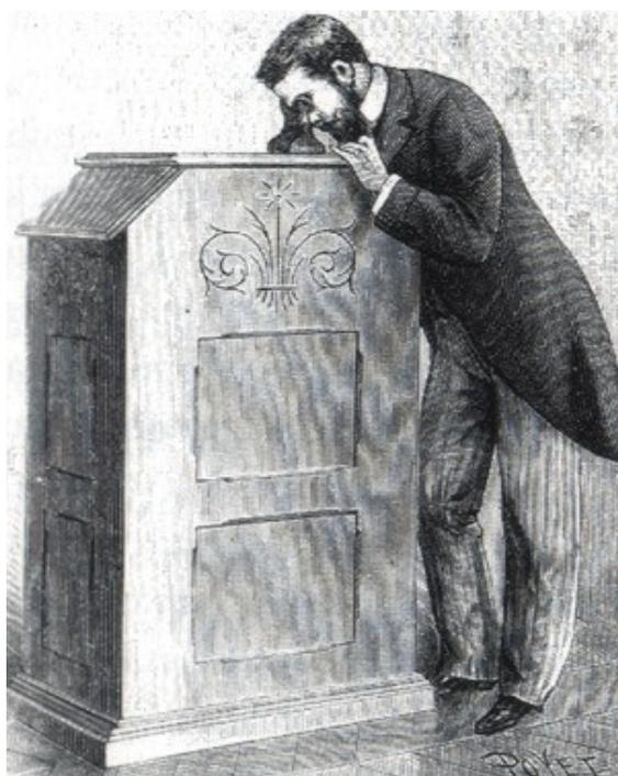
Figura 16: Kinetoscópio
