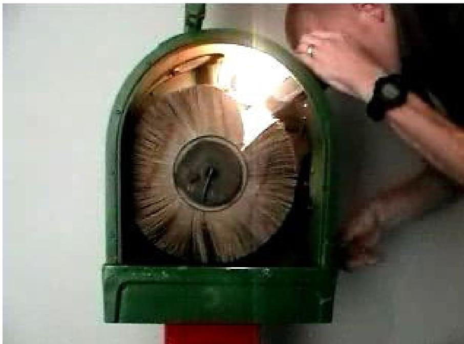
Figura 6: Mutoscópio em funcionamento.
