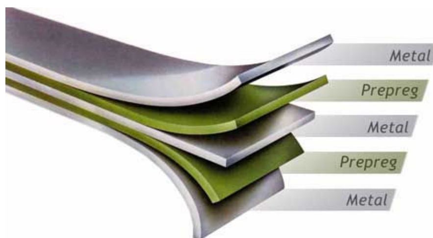
Figura 2.3 – Configuração de um compósito laminado metal-fibra (VLOT; SINKE, 2002 adaptado).
