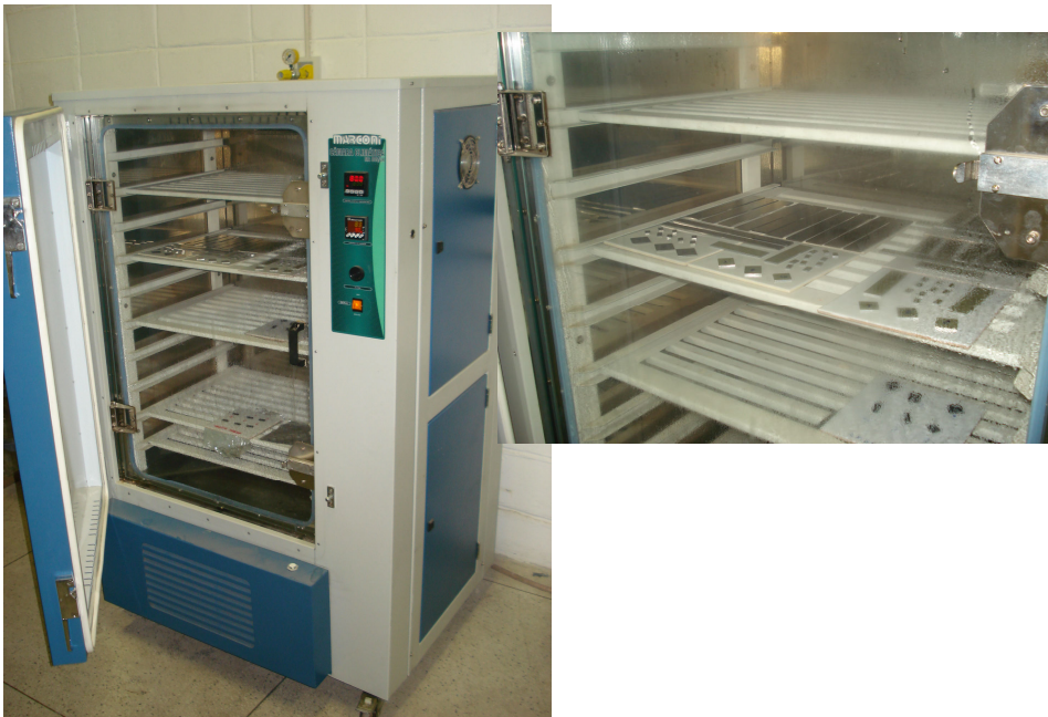
Figura 3.3 – Câmara climática modificada da Marconi modelo MA 835/UR.
