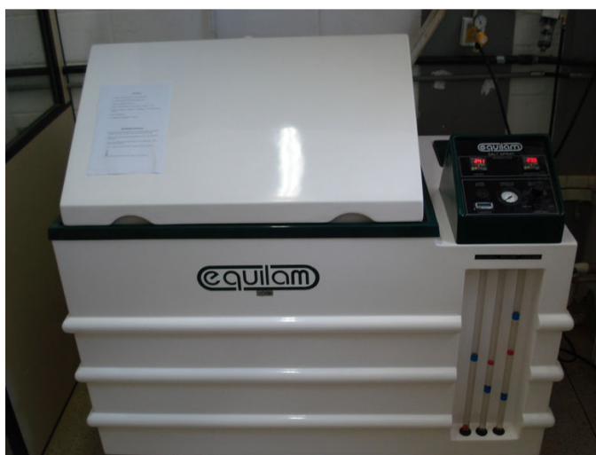
Figura 3.5 – Câmara de atmosfera salina da Equilam, modelo SS600e.
