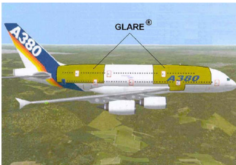
Figura 2.5 – Airbus A380 utilizando GLARE® como parte da fuselagem (SILVA, 2006).
