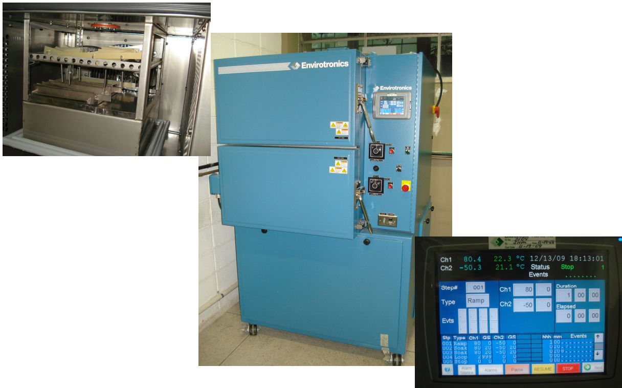
Figura 3.6 – Câmara de choque térmico utilizada no condicionamento por variação cíclica de temperatura, da Envirotronics, modelo TSV.5-2-2-2-AC-X.
