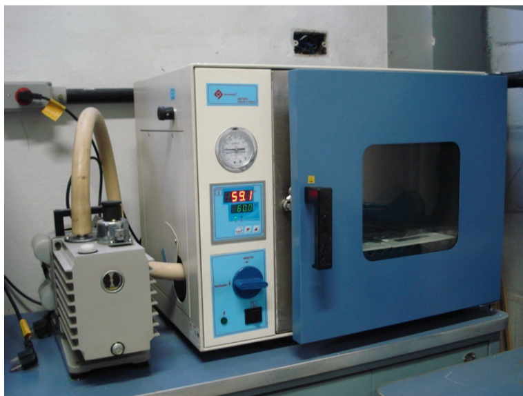
Figura 3.4 – Estufa a vácuo, da Quimis modelo Q819V2.
