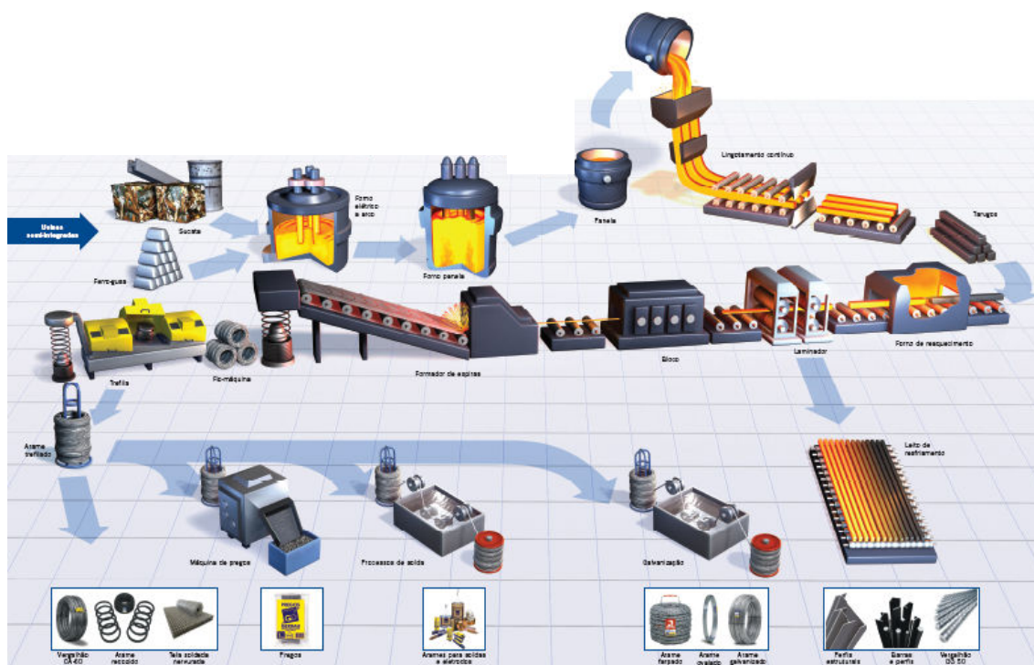
Figura 18 – Fluxo de uma usina siderúrgica semi-integrada
