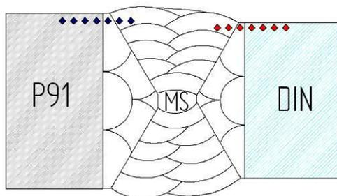
Figura 4.9 - Esquema dos perfis de dureza da seção transversal da solda dissimilar.
