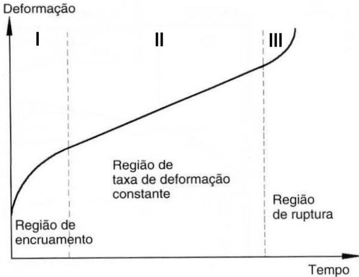
Figura 2.1 - Curva típica de deformação em função do tempo
