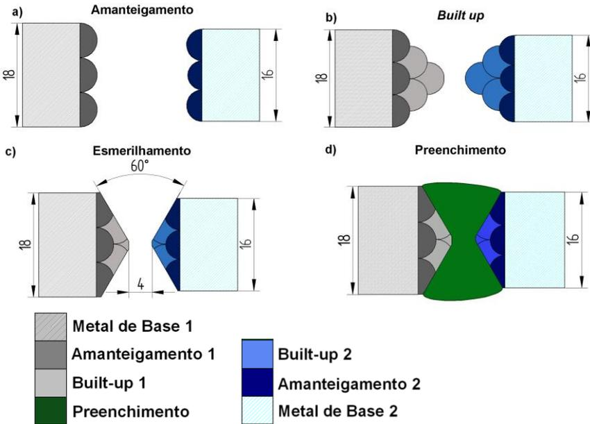
Figura 4.5 - Esquema da seqüência de soldagem.
