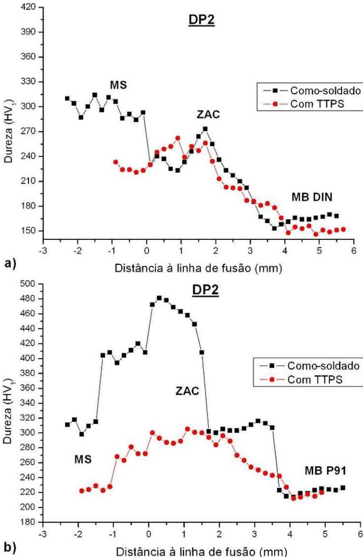
Figura 5.47 - Perfis de dureza da solda dissimilar DP2: a curva preta no estado como-soldado e a curva vermelha após TT de revenido.
