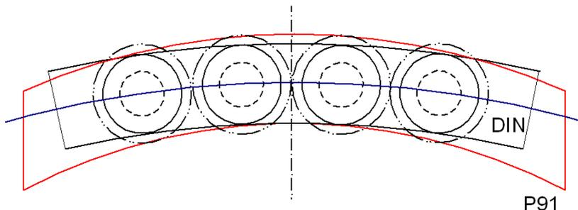
Figura 4.4 - Posicionamento dos tubos e locais de remoção dos CPs.
