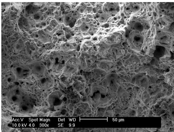
Figura 5.35 - Imagem obtida no MEV da superfície de fratura do CP DIN 05.
