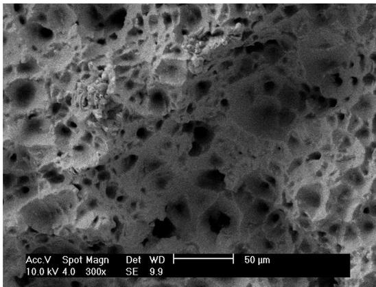
Figura 5.62 - Imagem obtida no MEV da superfície de fratura do CP DD1 (650 °C / 0,5 mm/min).
