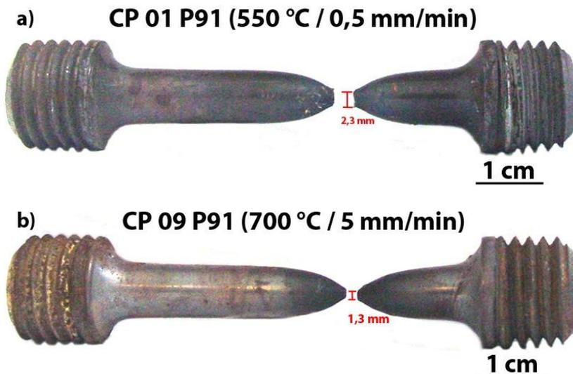
Figura 5.27 - Fotos de dois dos CPs em aço P91 fraturados no ensaio de TQ: (a) CP 01 e (b) CP 09.
