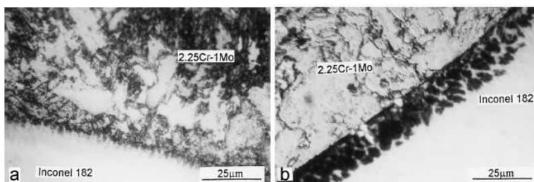
Figura 2.29 - Interface difusa da junta dissimilar (a) no estado como-soldado; (b) após tratamento térmico [31].
