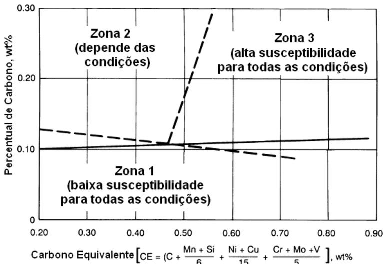
Figura 2.15 - Efeito do teor de C e do carbono equivalente sobre a susceptibilidade ao trincamento a frio na ZAC [25].
