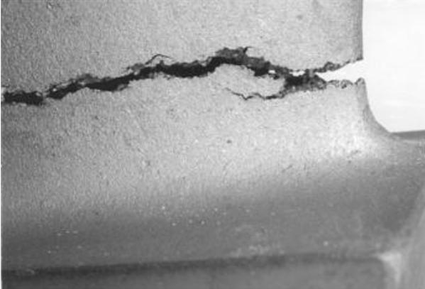
Figura 2.7 - Fratura por fluência em palheta de turbina [13].
