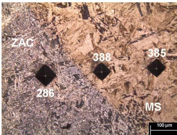
Figura 5.50 - Micrografia da solda dissimilar DP25 DIN antes do TT de revenido. Valores de dureza dados em HV. Ataque químico: Nital a 3%.
