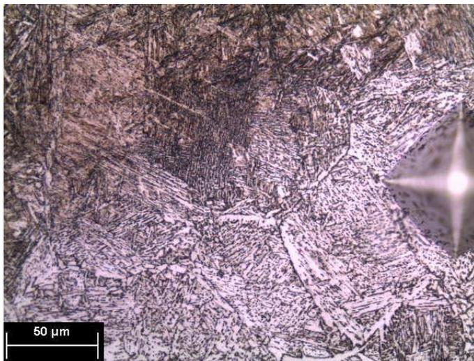
Figura 5.7 - Micrografia da ZAC-GG no aço DIN 14MoV6.3 produzida pela soldagem com energia de 12 kJ/cm. Ataque químico: Nital 3%.
