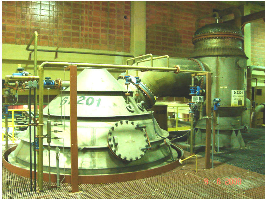
Figura 3.2: Vista do topo do cristalizador ligado ao condensador.
