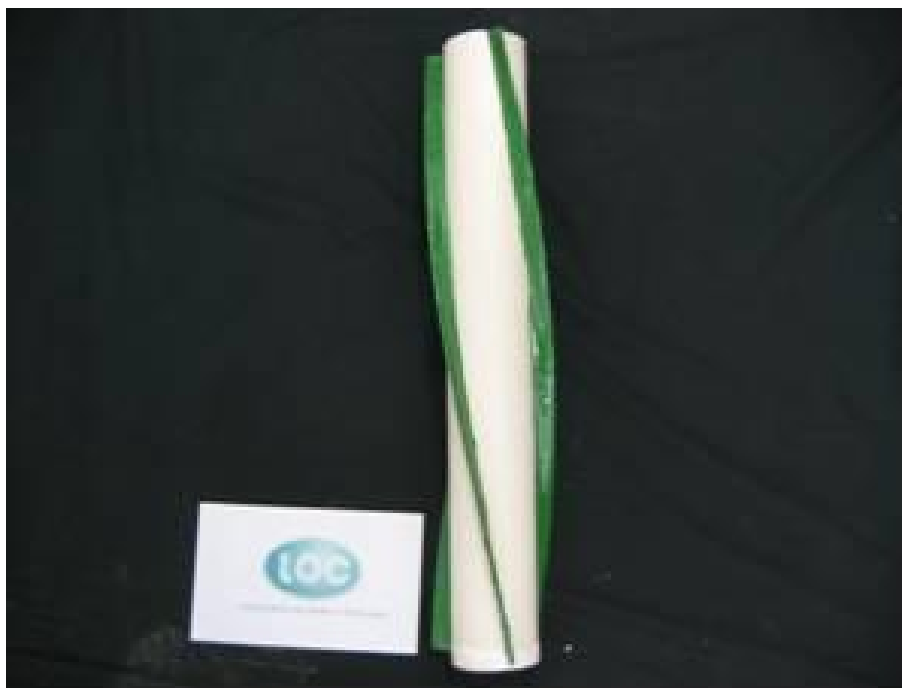
Figura 3.3.13 –Modelo 13 (com strakes )
