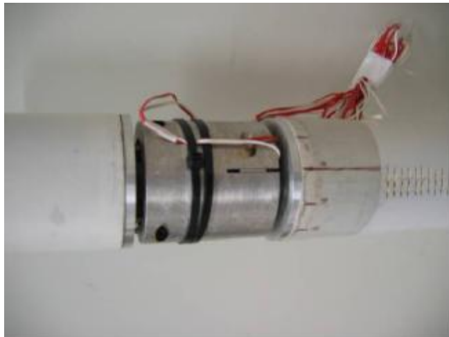
Figura A1.1.1 – Foto em detalhe da célula de carga acoplada ao modelo.
