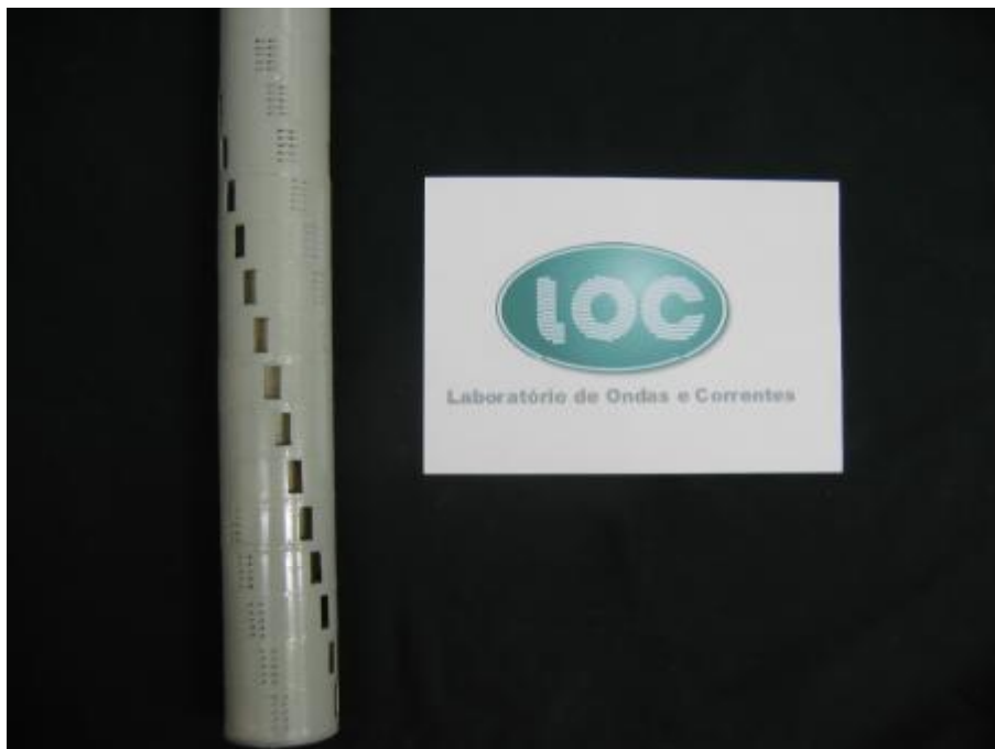
Figure 3.3.9 – Foto do Modelo 09 proposto como solução omni direcional para o estudo com um grau de liberdade.
