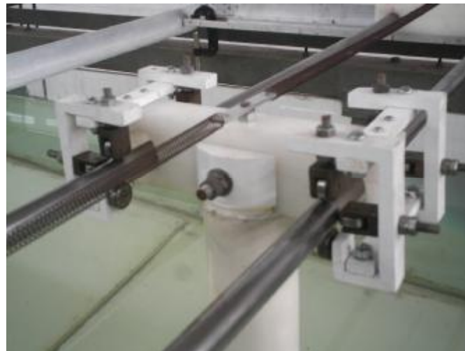
Figura 3.1.3 – Foto ampliada do sistema de sustentação dos modelos.
