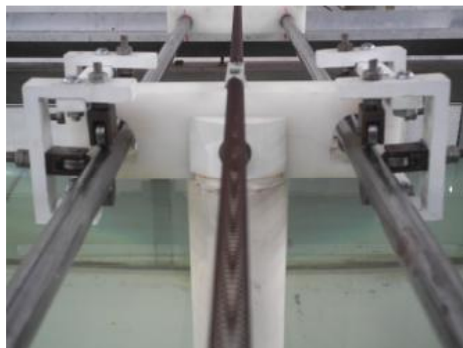
Figura 3.1.4 – Foto ampliada do sistema de sustentação dos modelos.
