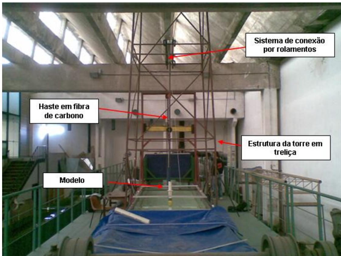
Figura 3.2.1 – Foto ampliada do sistema de sustentação do modelo.
