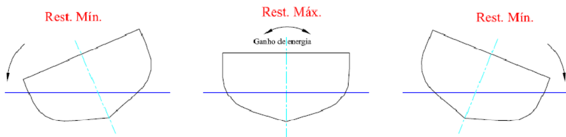
Fig. 1.7 Restauração e roll na ressonância paramétrica principal (relação de encontro 0.5:1)
