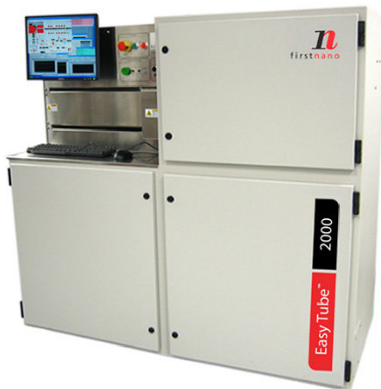
Figura 4.7. Sistema comercial automatizado utilizado para a síntese de NTC por DCQFV. Fonte: FirstNano, 2010.
