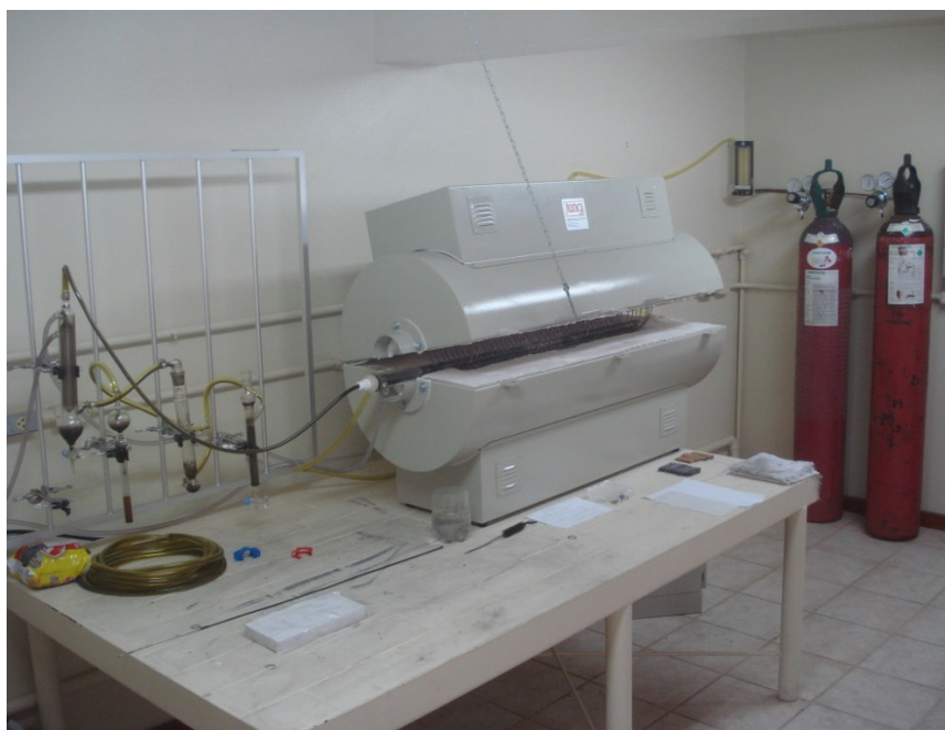
Figura 3.6. Fotografia do sistema DCQFV com o forno semi-aberto para a refrigeração mais rápida.
