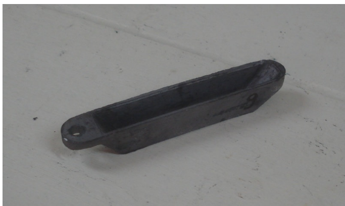
Figura 3.5. Barquinha de cerâmica utilizada como suporte do catalisador.
