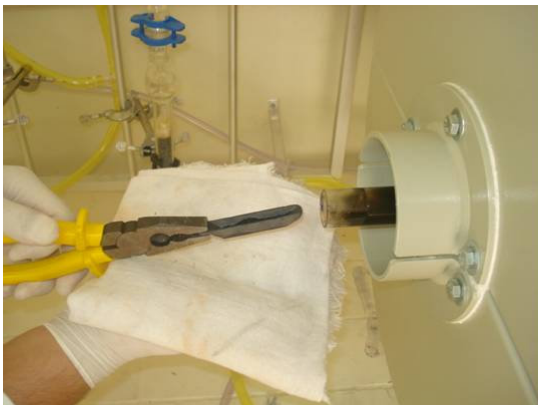
Figura 3.8. Fotografia do sistema DCQFV, no momento em que a barquinha com o NTC formado é retirada do forno.
