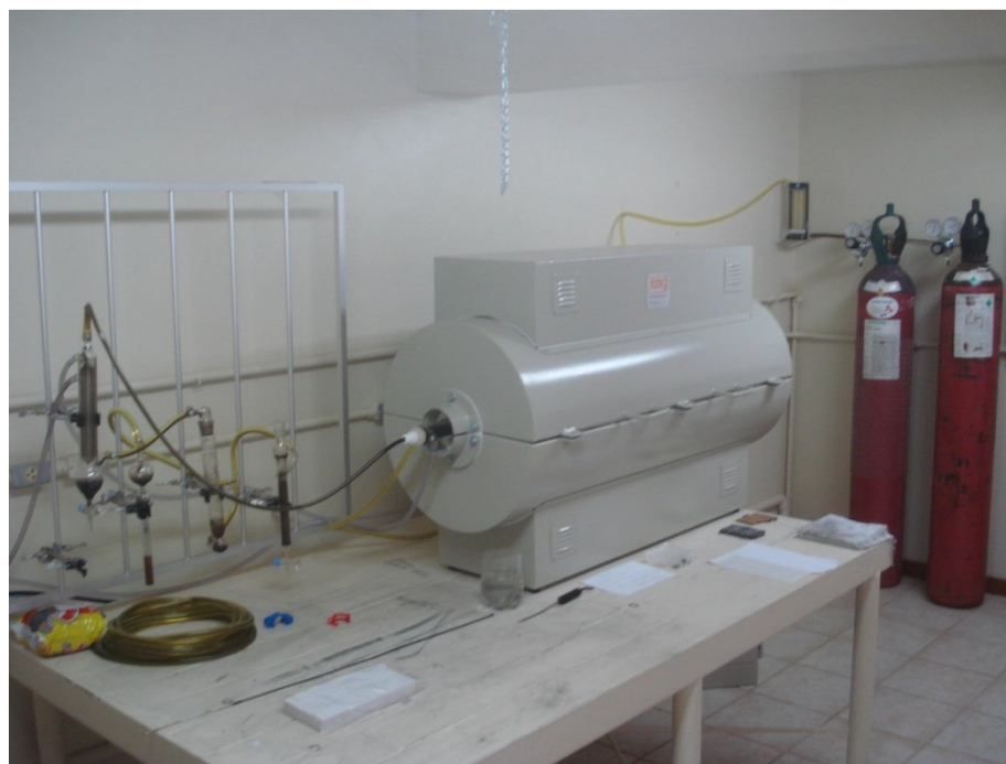
Figura 3.3. Fotografia do sistema DCQFV montado no Centro Universitário Franciscano.
