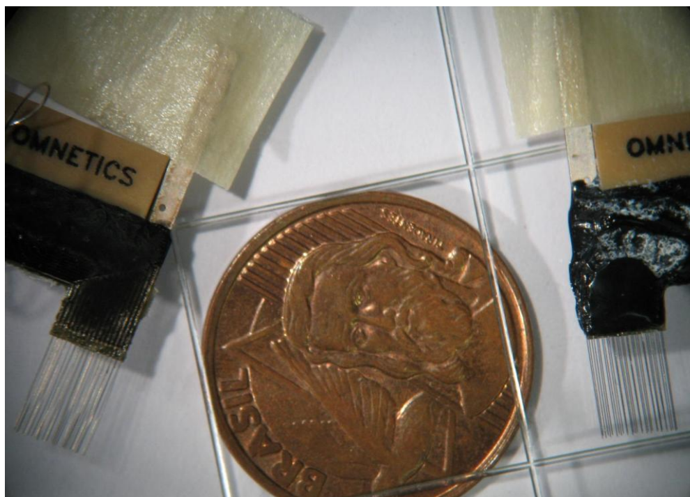
Figura 5 - Matrizes de eletrodos construídas na Duke University por Gary Lehew, utilizadas no início do trabalho, para treinamento cirúrgico e de registro. Os fios foram dispostos em arranjo 2 x 16 com espaçamento de 300 \mu\text{m} em ambas as direções. As matrizes foram colocadas sobre uma moeda brasileira de 5 centavos que serve como referência de tamanho na foto.
