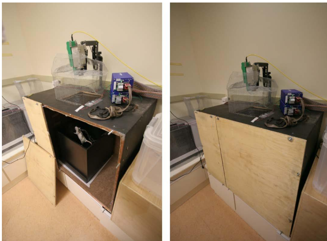
Figura 39 - Fotografias do aparato comportamental utilizado durante as sessões de registro. O animal ficava em livre movimentação dentro de uma caixa inserida em uma gaiola de Faraday maior com isolamento acústico e eletro-magnético. A foto da esquerda mostra a gaiola aberta apenas para ilustração. À direita foto do sistema como foi utilizado durante todas as sessões de registro, fechado.
