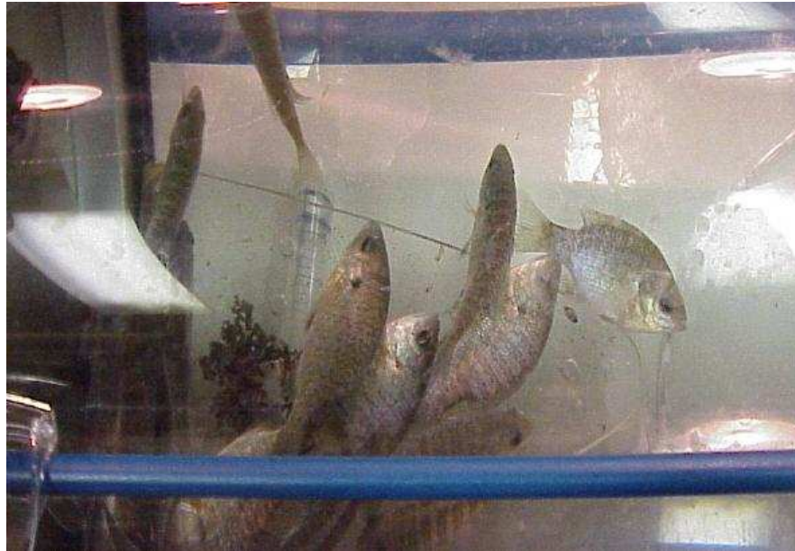
FIGURA 2.17 – Efeito nos peixes no momento de descompressão rápida pelo simulador de passagem por turbina.
