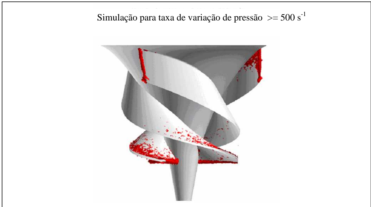
FIGURA 2.13 – Simulação em turbina amigável. Os pontos em destaque mostram as partes da turbina onde a taxa de cisalhamento atingem valores superiores a 500 /s. FONTE – Adaptado de Hecker e Cook (2005).
