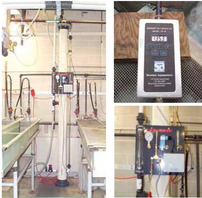
FIGURA 2.19 – Sistema para a supersaturação de gases dissolvidos na água e sensores de medição (saturômetro)
