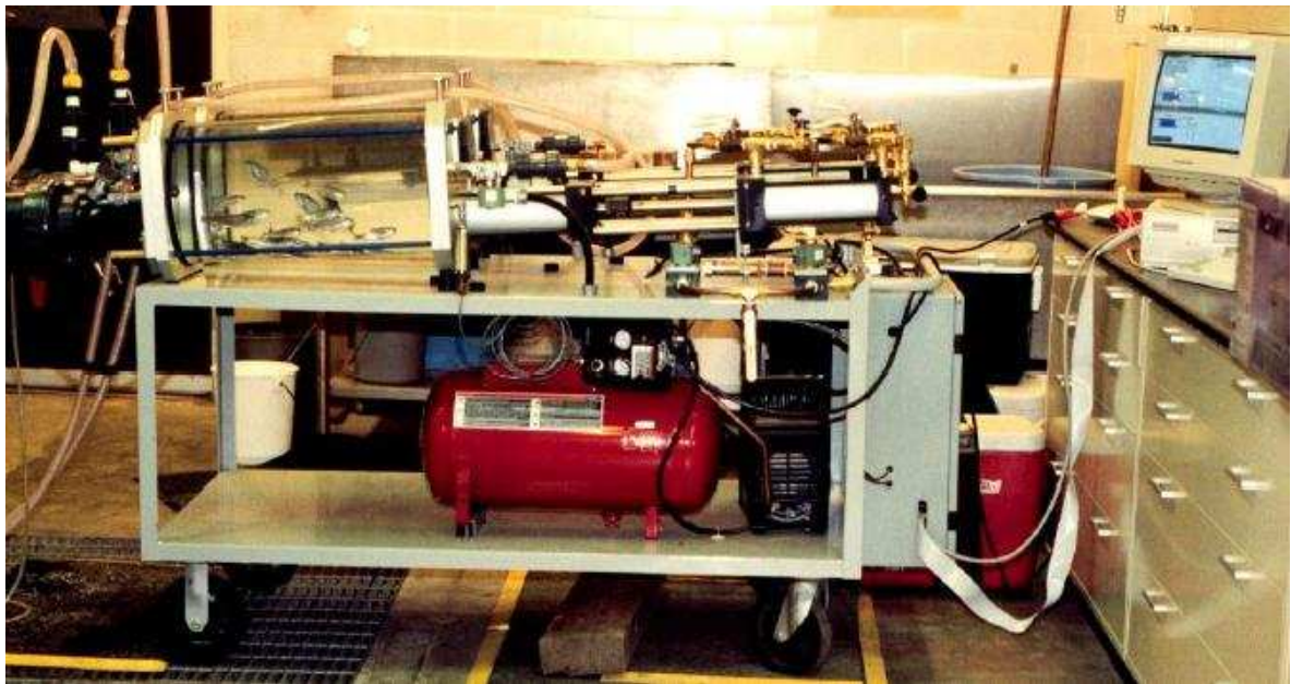
FIGURA 2.15 – Sistema simulador de passagem por turbina
