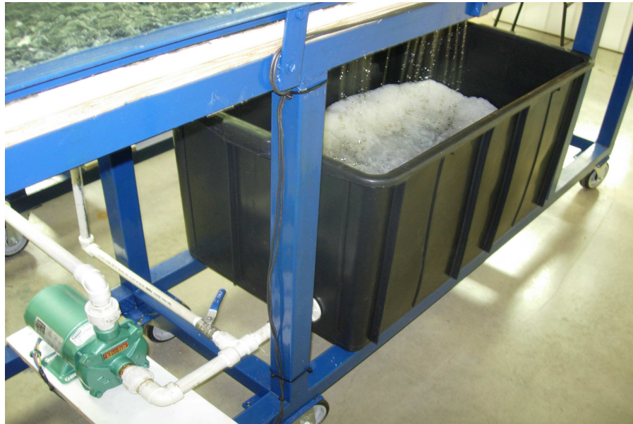
FIGURA 3.5 – Caixa do sistema de filtragem dos tanques de manutenção.
