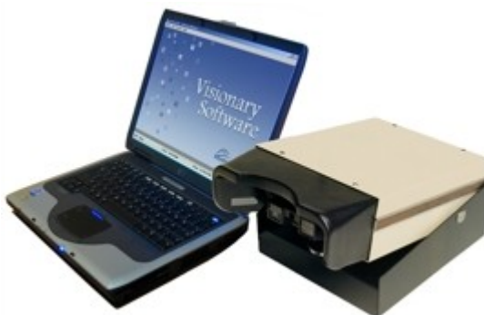
FIGURA 3.35 - Equipamento CVS-V GT produzido pela Keystone View. Apesar de ser controlado por um computador ainda apresenta o mesmo designer da patente de Griffin (1986).
