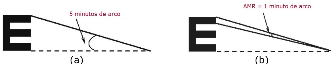
FIGURA 3.6 - Em (a) temos uma letra E com tamanho total de 5 minutos de arco. Em (b) a representação de um segmento da letra contendo 1 minuto de arco. Estas letras estão na escala MAR cujo valor da acuidade equivale a 1. Na letra E todos os segmentos e espaços intermediários tem espessura equivalente a 1 minuto de arco.
