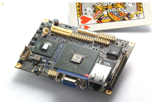
FIGURA 4.6 - Placa pico-itx da VIA, é uma das menores placas existente para computadores, mede 10 cm x 7,2 cm, tamanho um pouco maior ao de uma carta de baralho.
