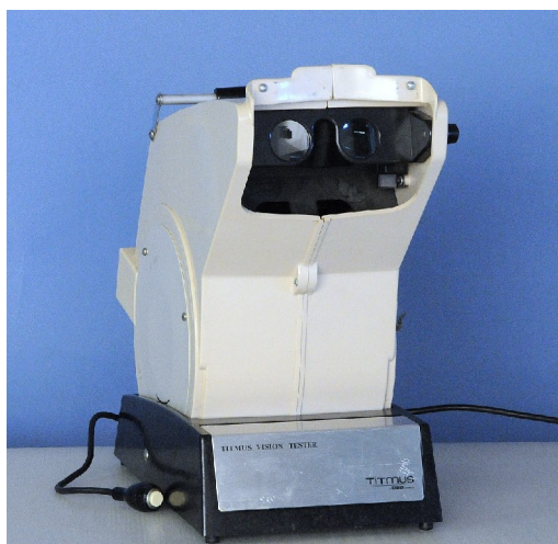
FIGURA 3.31 - Titimus Vision Tester, descontinuado em 1986. Apresenta semelhanças com o equipamento desenvolvido por Good em 1975.
