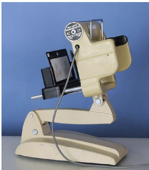
FIGURA 3.30 - Equipamento desenvolvido por Mast e Gannet em 1948 e vendido pela empresa Keystone View. Tem o mesmo princípio de funcionamento do equipamento desenvolvido por Sherman em 1935.
