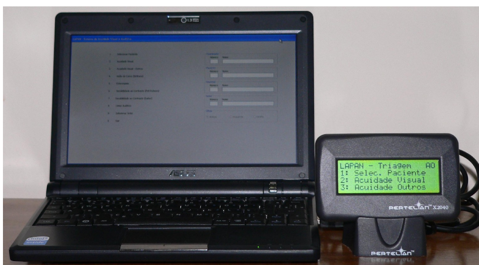
FIGURA 5.3 - Display LCD de caracteres Pertelian X2040 sendo controlado pelo netbook Asus EEE PC900.
