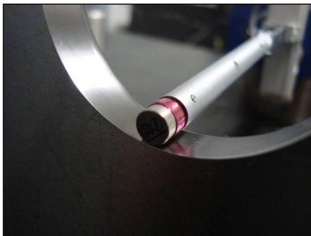
Figura 3.19 - Medição dos desvios microgeométricos no interior da cavidade da matriz
