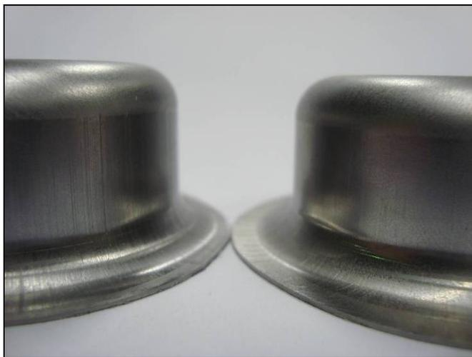
**Figura 4.27 - Aparência superficial da lateral do corpo de prova (imagens a olho nu): matriz fresada (esquerda) e matriz polida (direita)**
