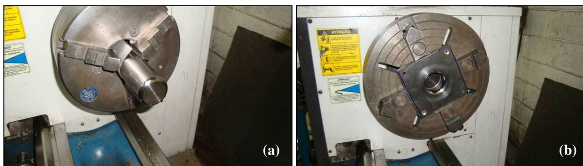
Figura 3.9 – (a) Torneamento do punção e (b) da matriz
