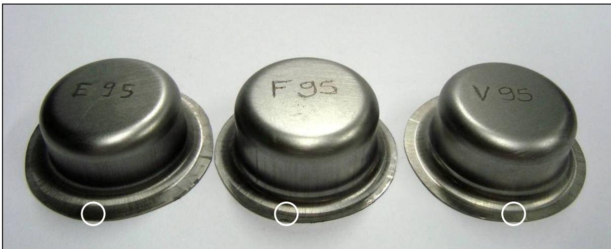
Figura 4.25 - Local de ampliação próximo ao raio de canto da matriz. Eletroerodida (esquerda), fresada (centro) e torneada/polida (direita)
