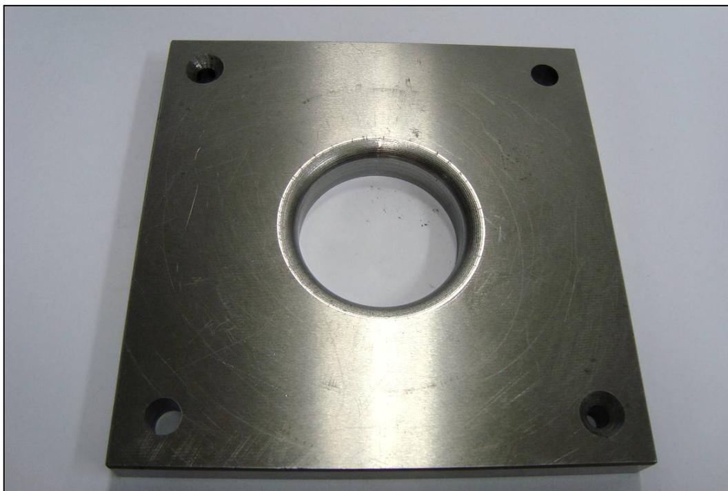
**Figura 3.17 - Matriz gerada através do processo de fresamento**
