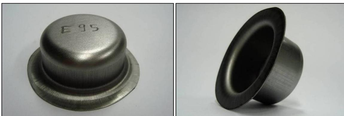
**Figura 4.20 - Testes de Swift sem o rompimento do corpo de prova**
