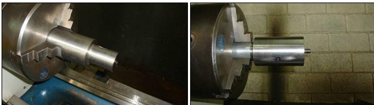
Figura 3.8 – Torneamento do adaptador com engate rápido
