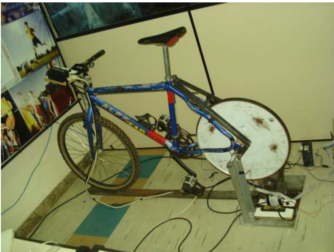
FIGURA 3.1 – Bicicleta acoplada á estrutura de sustentação.
