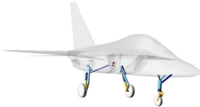
*Figura 1.2: Protótipo virtual multicorpos de uma aeronave (Ghiringhelli, 2000).*
