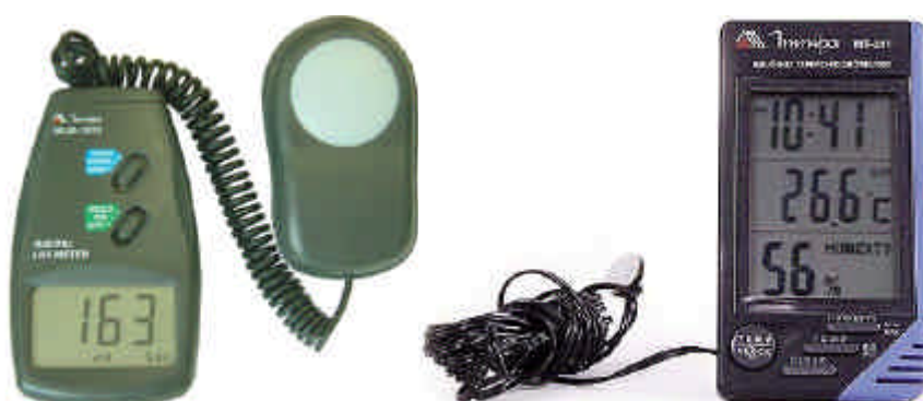
Figura 4.5 – À esquerda um luxímetro digital e à direita um termo-higrômetro digital; utilizados no monitoramento da luminosidade, da temperatura e da umidade relativa.
