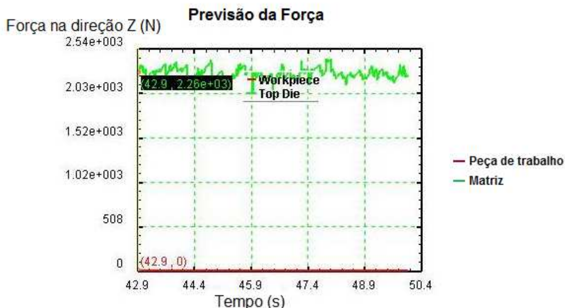
Figura 4.4 – Força sobre a fieira de semi-ângulo 9° na direção da trefilação realizada pela tração do quarto do vergalhão de diâmetro 8 mm.
