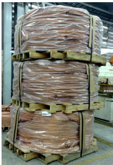
Figura 2.1 – Embalagem da matéria prima - vergalhão de cobre eletrolítico (OLIVEIRA, 2009).
