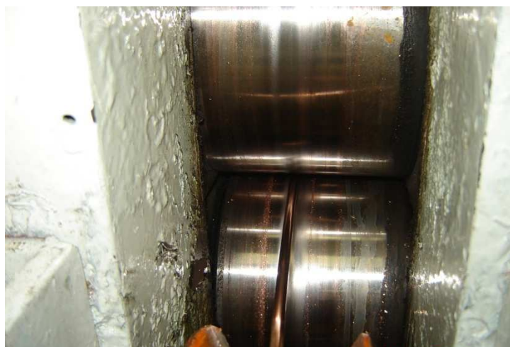
Figura 2.11 – Processo de laminação da TTDB (OLIVEIRA, 2009).
