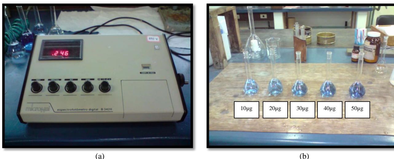
Figura 15: ensaio NBR 9848/2004. (a) espectrofotômetro visível; (c) amostras preparadas para curva de calibração do ensaio
