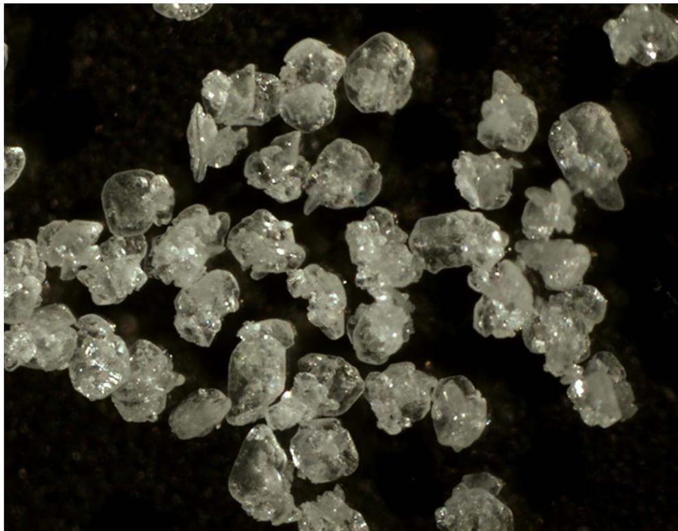
**Figura 4.31:** Cristais obtidos em escala industrial, retidos na malha de 0,350 mm.
