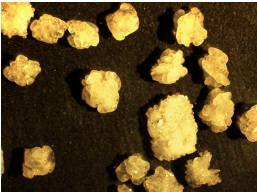
**Figura 4.24:** Ensaio 1A; cristais retidos na malha de 1,000 mm.
