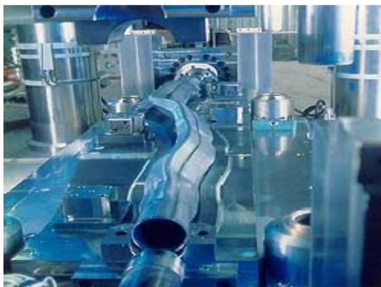
Fig. 2.16 Perfil já pré-conformado (METAL FORMING HANDBOOK, 1998).
