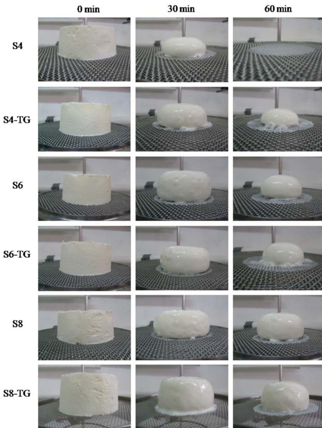
**Figura 3.2.** Ilustração do comportamento de derretimento após 0, 30 e 60 minutos de exposição das amostras de sorvete a temperatura ambiente (25 °C).
