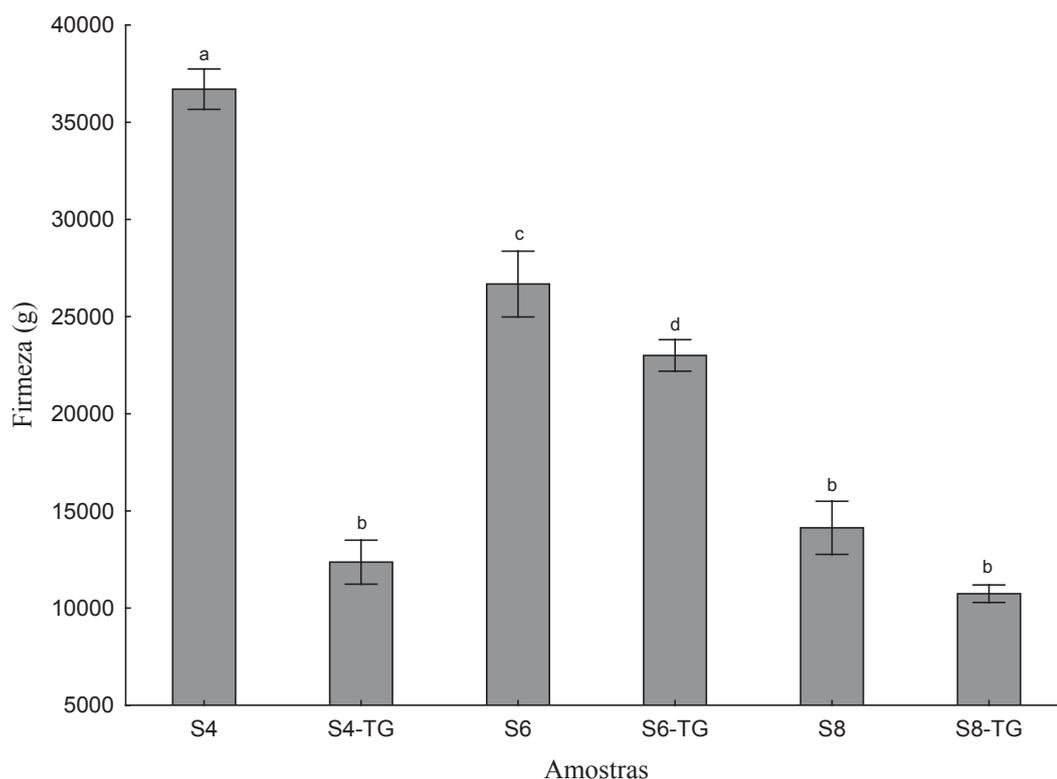
**Figura 3.5.** Firmeza dos sorvetes obtida através da análise de textura experimental expressos em força (g).
