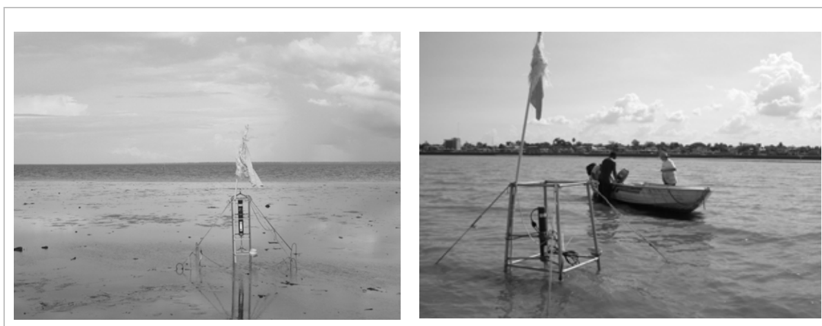
Figura 17. Estações fixas no interior das planícies com ADVs para a coleta de dados de níveis (sensor de pressão) e velocidades ( Doppler ). Os registros de velocidades foram coletados a 20 cm do fundo (foi assumida representativa da velocidade média na vertical). Estação ADV2 na parte superior da planície (esquerda) e estação ADV1 na parte inferior (direita). As estruturas para suporte dos equipamentos são de aço inox e fixas ao chão com varas de aço de 2 m de comprimento. Para evitar acidentes com tráfego de embarcações os equipamentos foram sinalizados.
