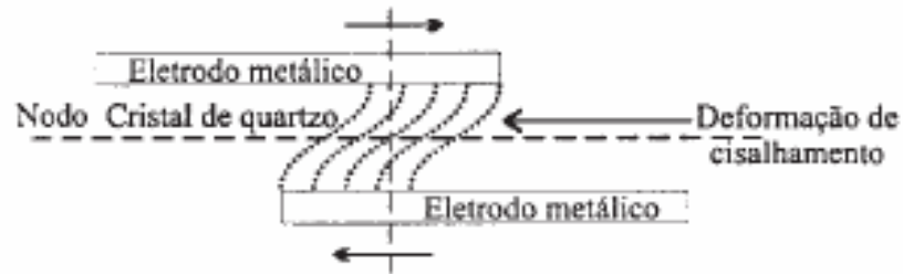
Figura 23: Nodo da onda acústica passando pelo centro do disco e a deformação causada pelo cisalhamento [54].
