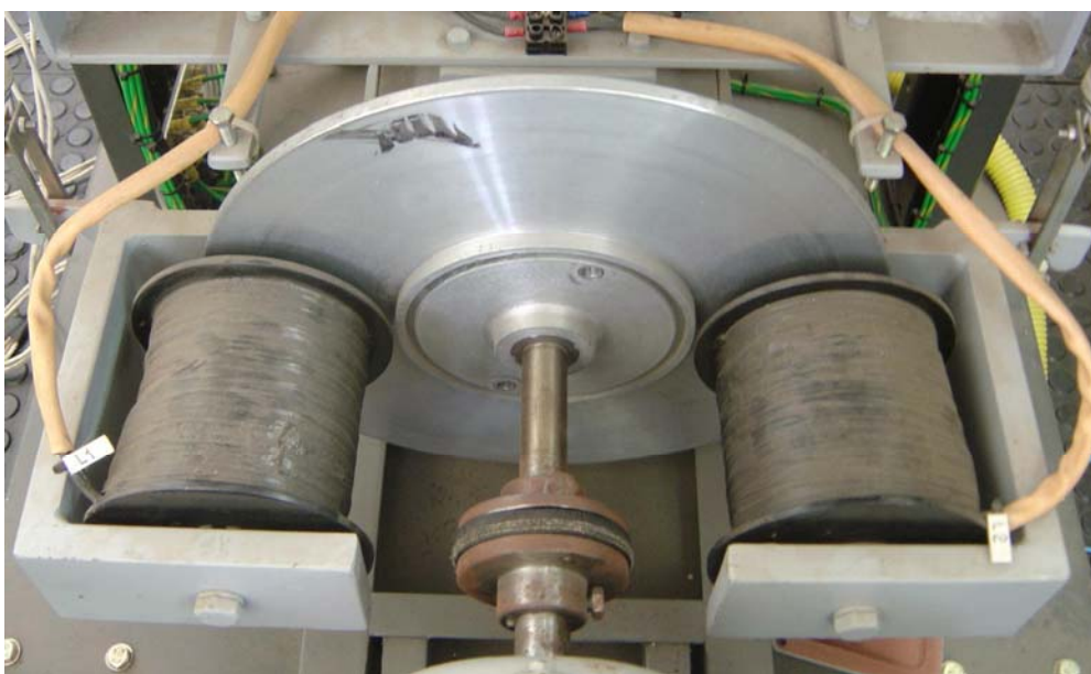
Figura 3.17 – Freio de Foucault acoplado ao eixo do MIT.
