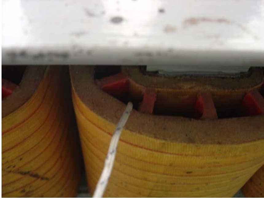
Figura 3.19 – Inserção do termopar.
