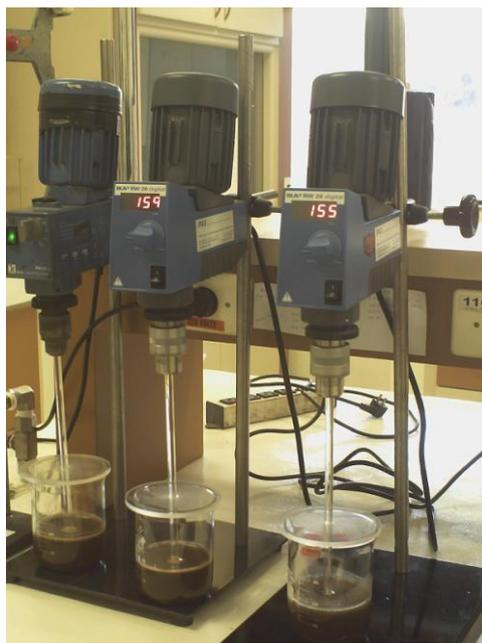
FIGURA 8 – Montagem experimental para os ensaios de lixiviação da lama
