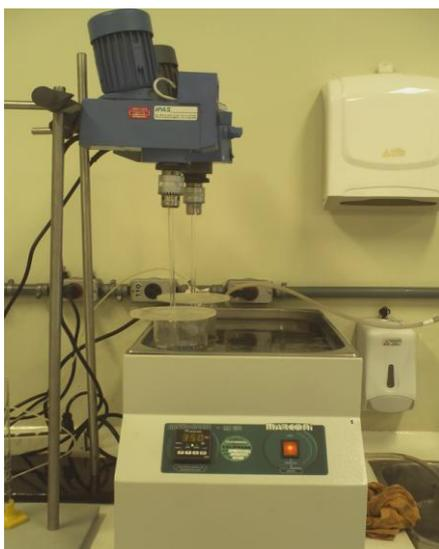
FIGURA 9 – Montagem experimental para o estudo da influência da temperatura nos ensaios de lixiviação alcalina do urânio
