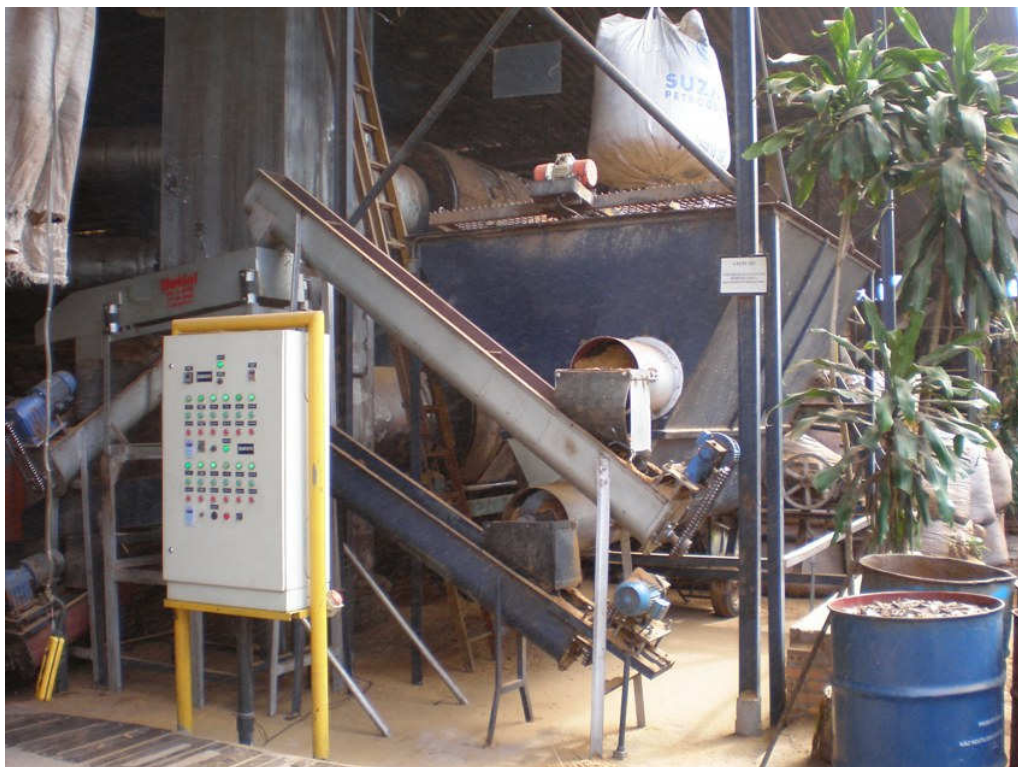
Figura 6 – Alimentação de cavaco para utilização nos fornos cerâmicos Fonte: Fotografia feita pelo autor do estudo.
