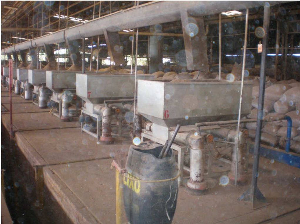
Figura 7 – Alimentação de serragem para utilização nos fornos cerâmicos Fonte: Fotografia feita pelo autor do estudo.
