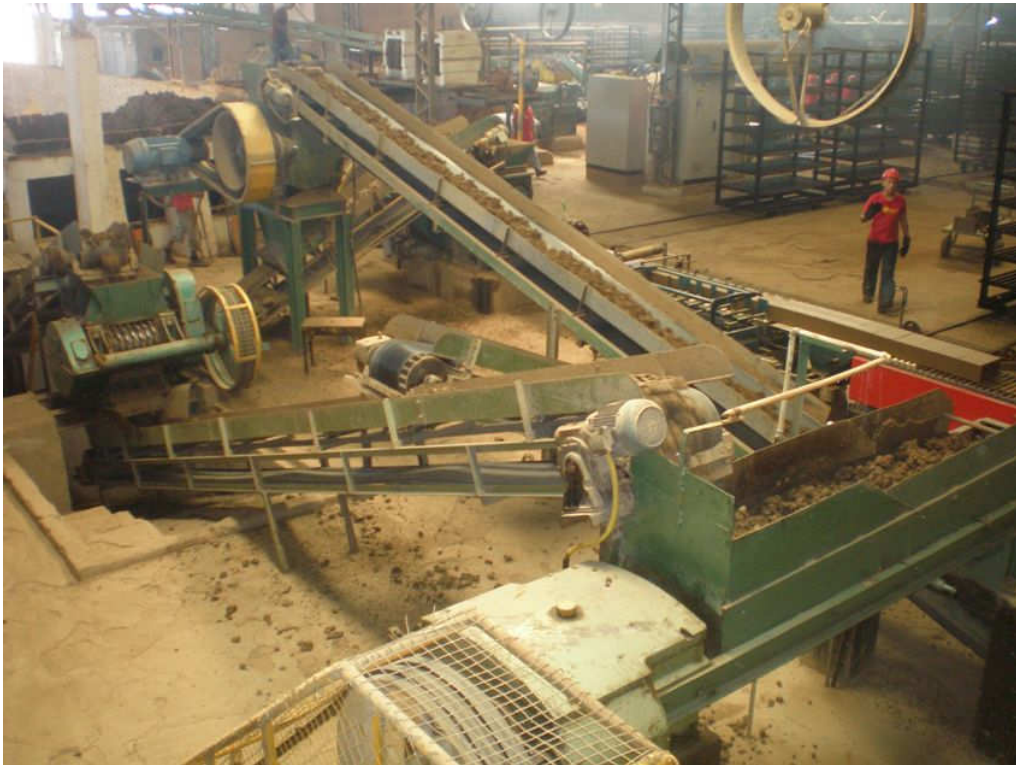
Figura 3 – Processo produtivo do pó cerâmico automatizado Fonte: Fotografia feita pelo autor do estudo.
