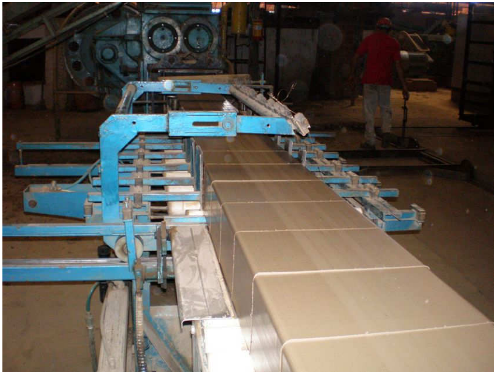
Figura 5 – Corte automatizado dos blocos estruturantes Fonte: Fotografia feita pelo autor do estudo.
