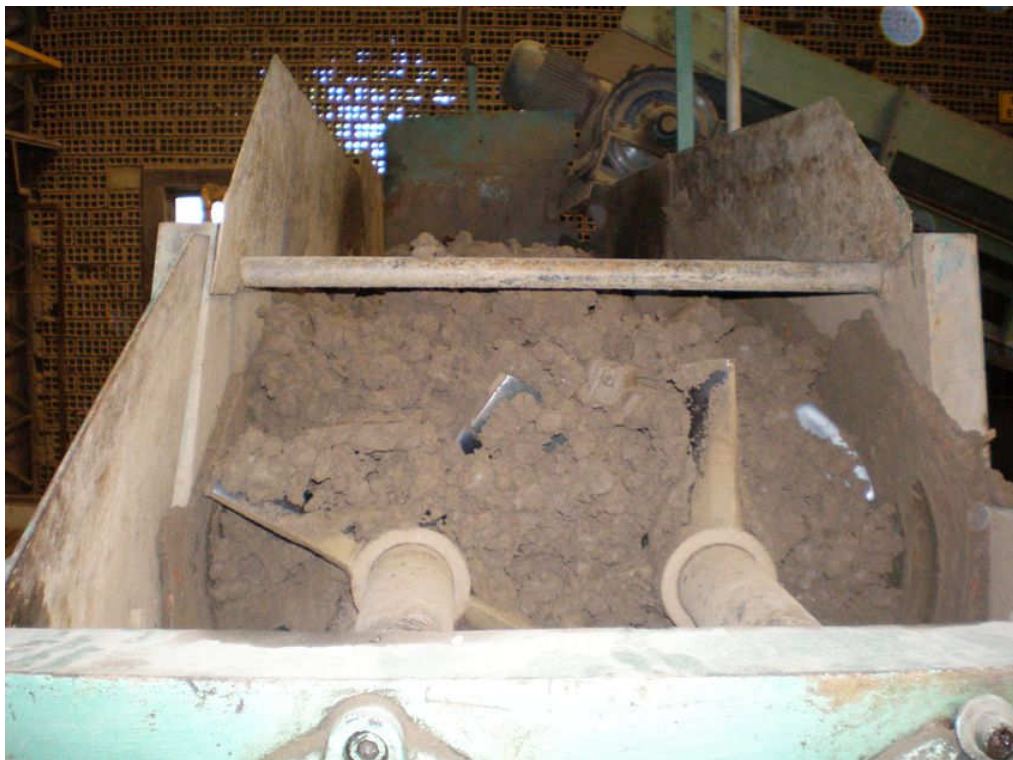
Figura 4 – Mistura mecanizada da argila Fonte: Fotografia feita pelo autor do estudo.
