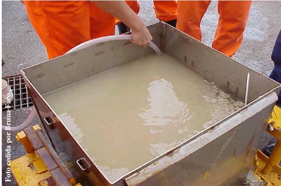
Figura 18. Retirada da água de interface com o sedimento.
