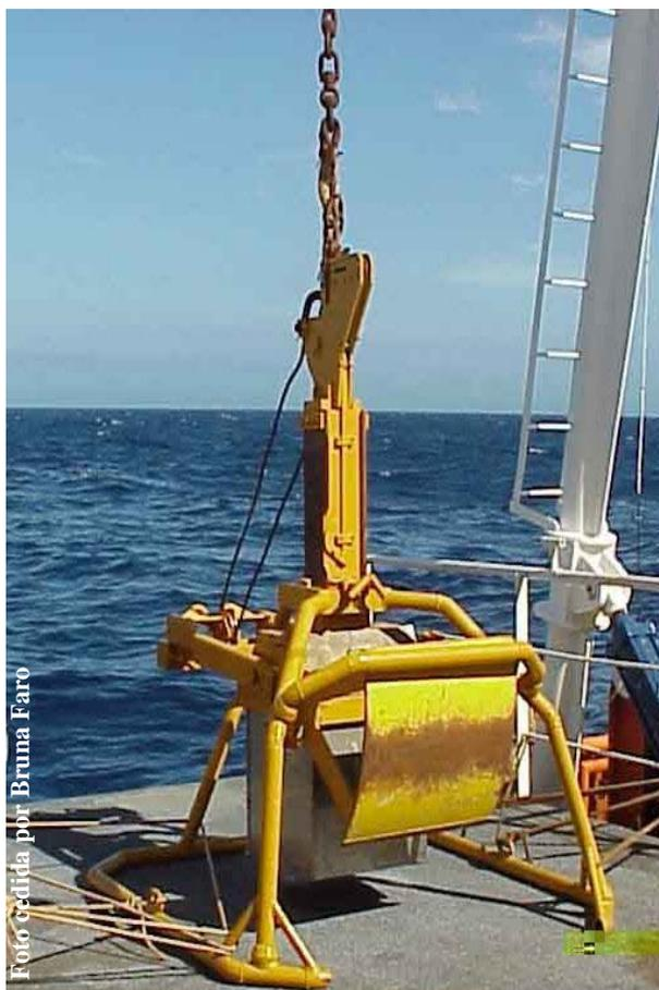
Figura 17. Coletor de fundo do tipo box-corer utilizado na coleta das amostras.
