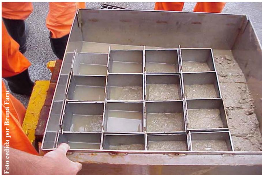
Figura 19. Amostra de sedimento após inserção das colméias.
