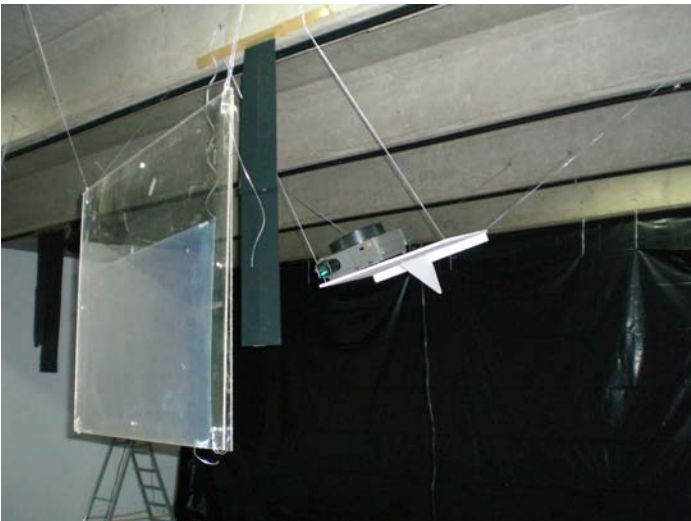
FIG.49 Detalhe do posicionamento do equipamento para projeção em uma das Telas de Malha Holográfica.
