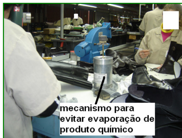
Figura 18: Mecanismo para evitar evaporação de produto químico
