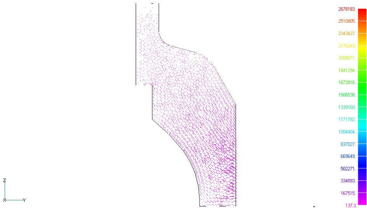
Figura 64 Distribuição do fluxo de calor nas aletas do dissipador Zalman modelo CNPS7000A..
