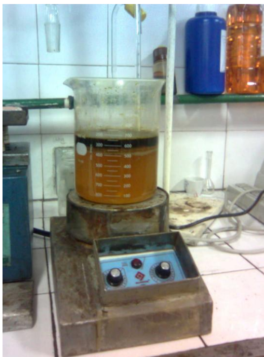
Fotografia 3 - Decantação da água – acidulação Fonte: Elaborado pelo autor
