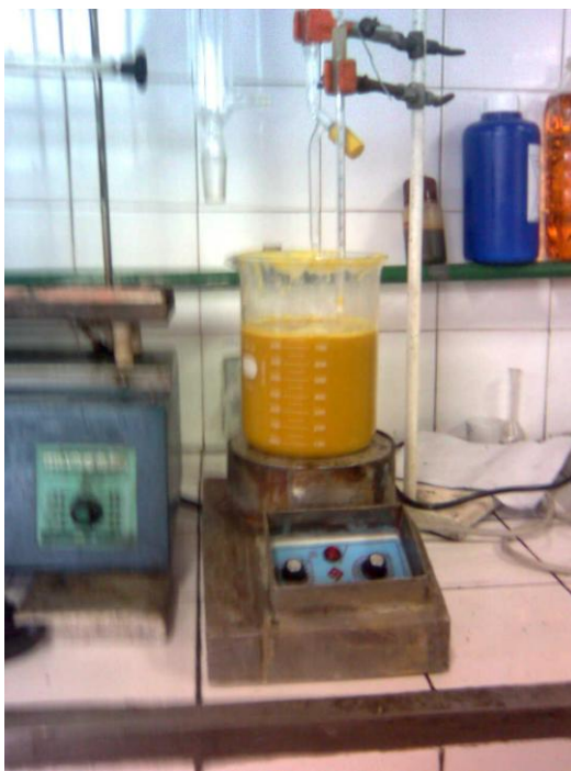
Fotografia 2 - Agitação da borra – acidulação Fonte: Elaborado pelo autor
