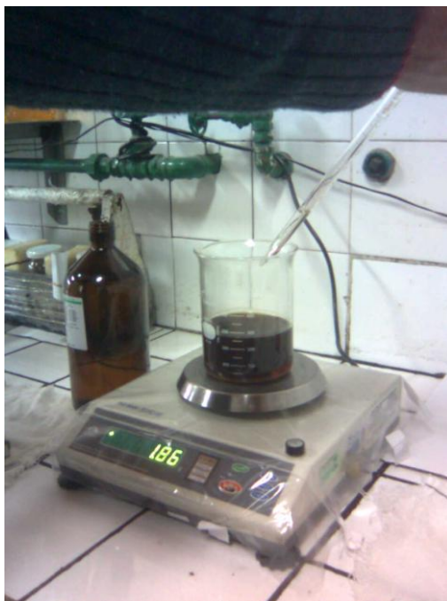
Fotografia 7 - Adição de H 2 SO 4 – pós transesterificação
