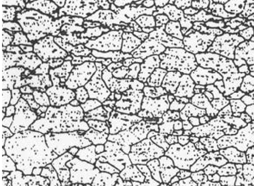
Figura 2.19 Microestrutura típica de um aço inoxidável ferrítico [ 43 ].
