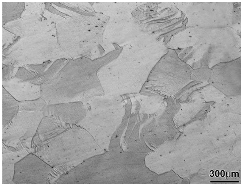
Figura 4.30 - Microestrutura de amostra tratada a 700 °C por 60 minutos.
