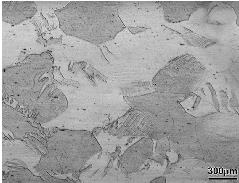
Figura 4.23 Microestrutura de amostra após 240 minutos a 700 °C.
