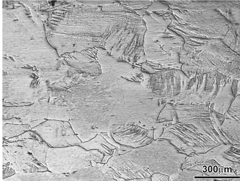
Fig. 4.7 Microestrutura após trefilação com 50% de redução.
