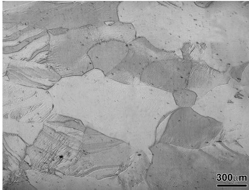
Figura 4.27 - Microestrutura de amostra tratada a 550 °C por 60 minutos.
