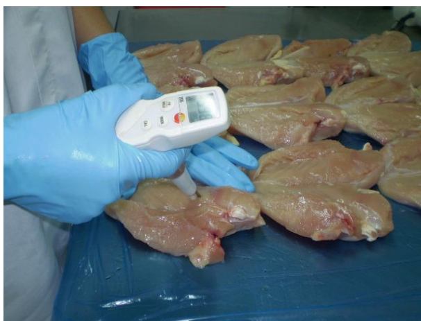
Figura 4: Aferição de pH de amostras de filé de peito de frango ( Pectoralis major ).
