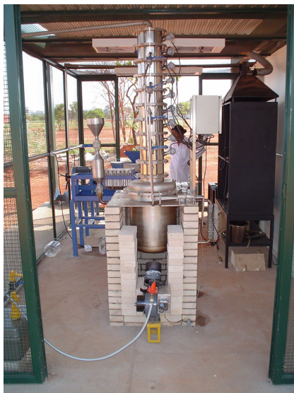
Figura 4.8: Protótipo de planta de craqueamento de óleo vegetal e gordura animal (RUBIN, 2005).
