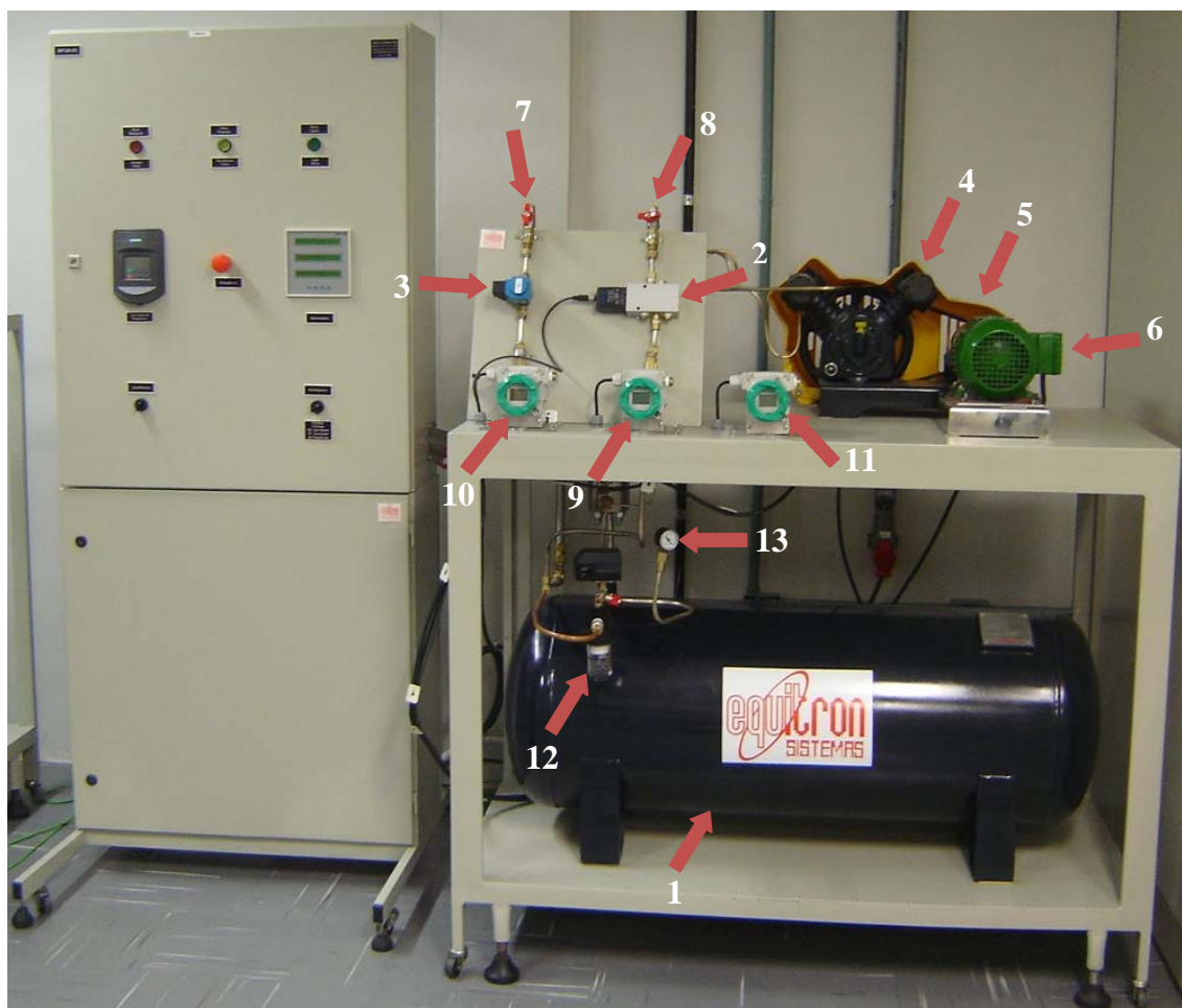
Figura 2.1 Foto do protótipo de carga da bancada de compressão de ar localizada no LAMOTRIZ utilizada para os experimentos deste trabalho.
