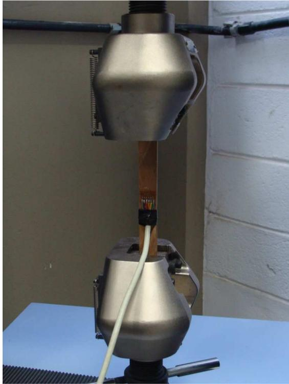
Figura 3.16 – Ensaio de tração **off-axis** corpo de prova LT.
