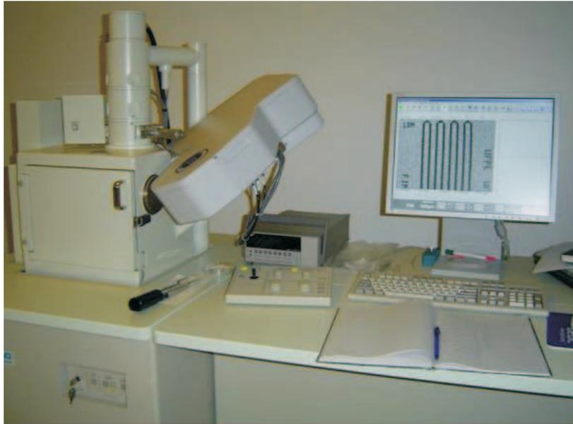
Figura 4.7: Microscópio Eletrônico de Varredura *JEOL6460*.
