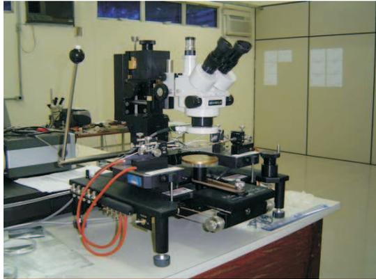
Figura 4.17: Aparato experimental utilizado para medição de 4 pontas.
