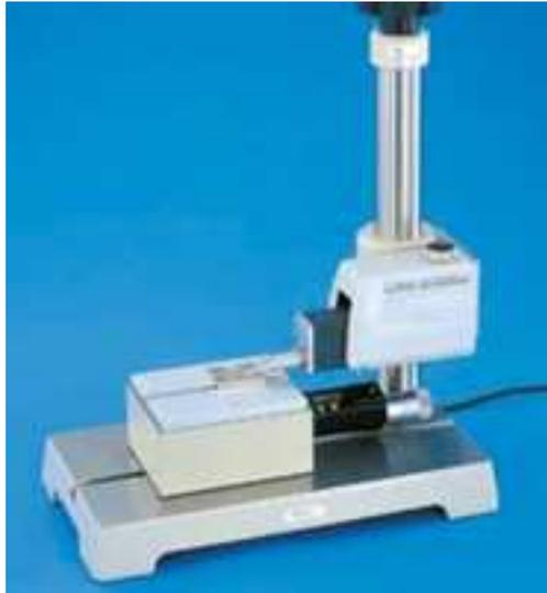
Figura 4.1: Perfilômetro *Mitutoyo SJ - 401*.
