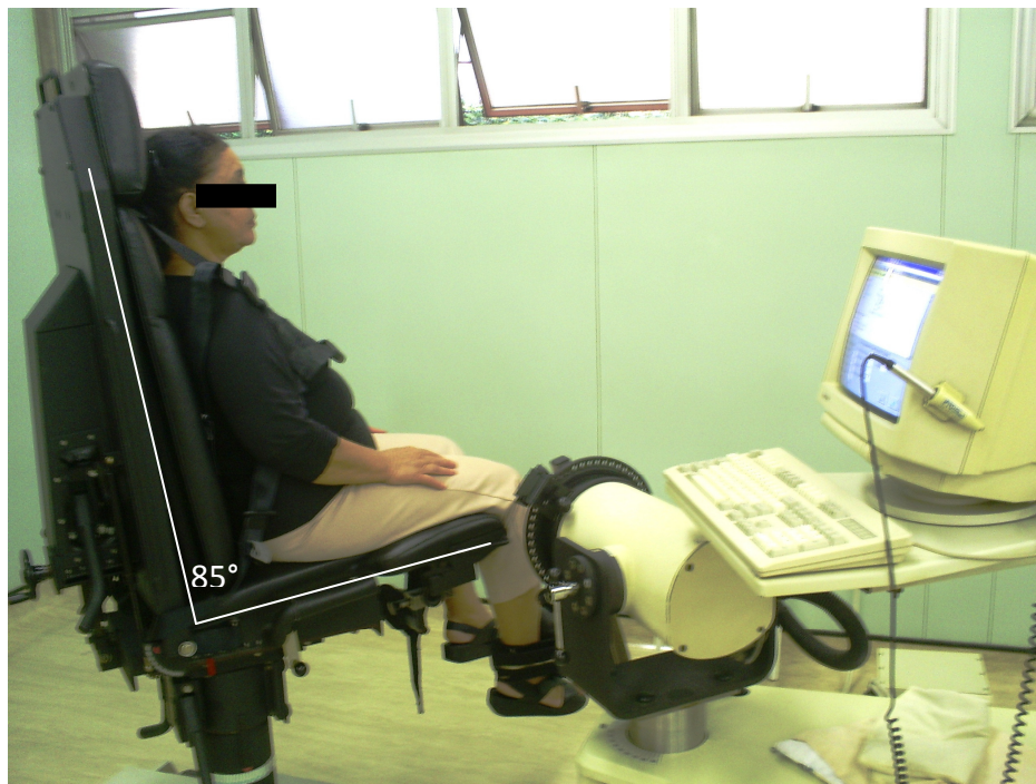
FIGURA 6 - Posicionamento do idoso para avaliação da musculatura do joelho em dinamometria isocinética.
