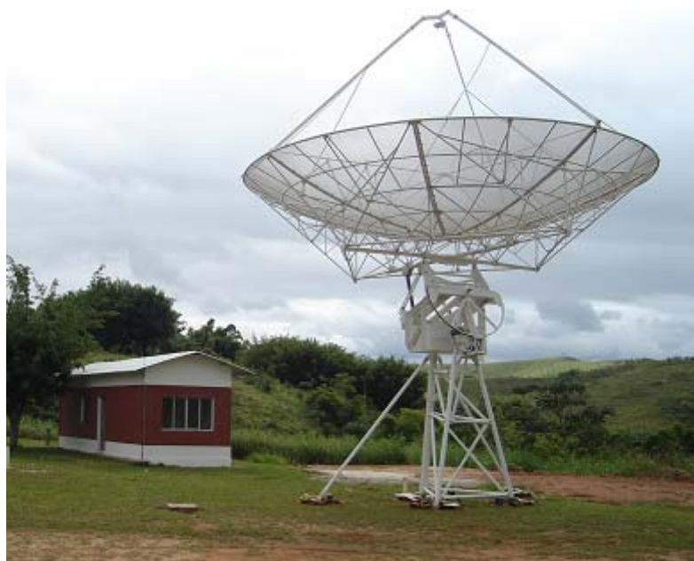
Figura 3.1 - Antena de 9 metros de diâmetro do BSS instalada no campus do INPE, em Cachoeira Paulista/SP.
