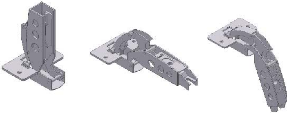
Fig. 21- Desenho 3D da dobradiça conceito desenvolvida, respectivamente: vistas fechada, semi-aberta e com abertura máxima. (SALVADOR, 2003, p.95)
