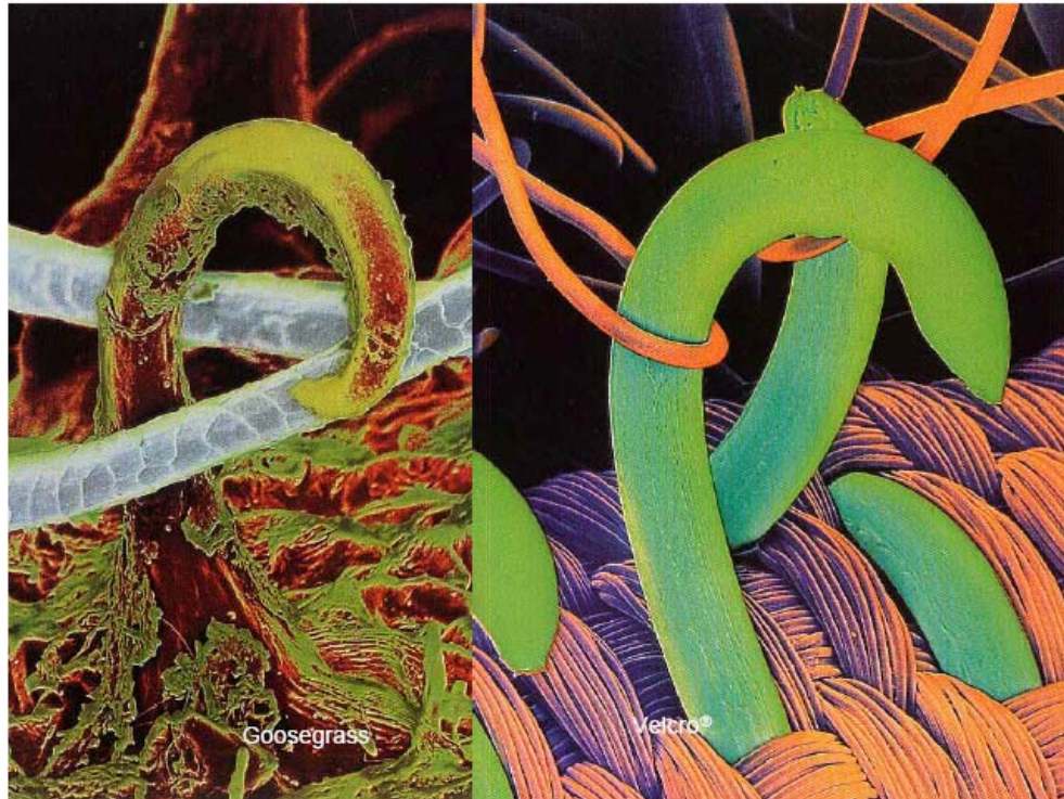
Fig. 29- Do lado esquerdo, imagem microscópica do carrapicho; do lado direito, imagem microscópica do velcro feito em plástico. A analogia se deu graças à percepção, por seu inventor, Georges de Mestral, de que a existência de pequenos ganchos conectores, similares aos do carrapicho, e de pequenas voltas, similares a qualquer superfície têxtil, gerariam uma aderência de fácil manipulação para conexão e abertura. “O nome VELCRO é uma referência às palavras em francês velours (que significa veludo ) e crochet (que significa gancho )” (WIKIPEDIA, disponível em http://pt.wikipedia.org/wiki/Velcro ).
