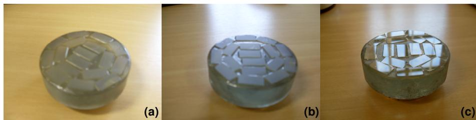
Figura 2.3 - (a) Diferentes etapas do processo de polimento: (a) carbetto de silício  $400\mu\text{m}$ , (b) alumina  $9.5\mu\text{m}$ , (c) polimento óptico alumina  $0.3\mu\text{m}$ .
