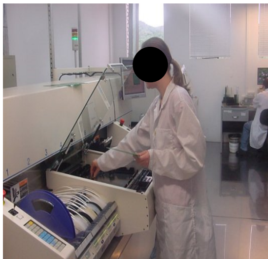
Figura 9 – Execução da montagem automática de placas eletrônicas
